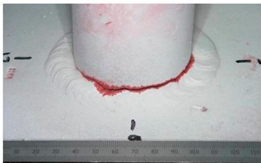
รูปที่ ๖๔ การทดสอบด้วยสารแทรกซึม (Penetrant Testing - PT)
