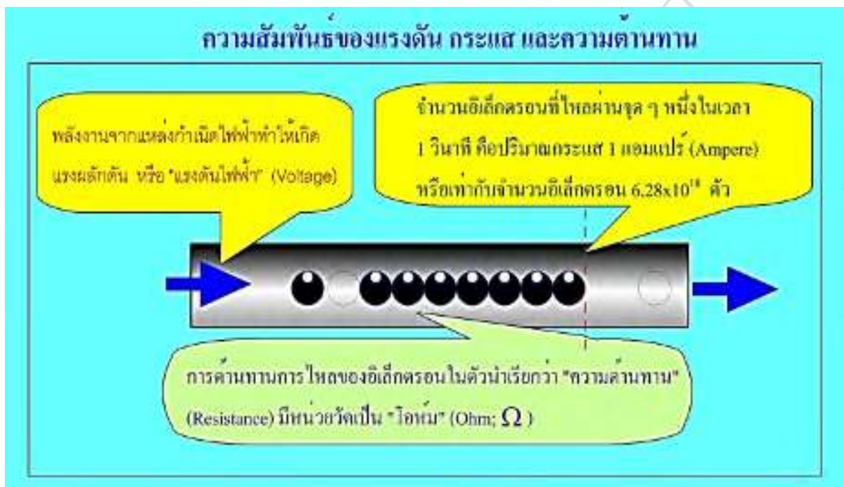
ภาพที่ 50 แสดงความสัมพันธ์ของแรงดัน กระแส และความต้านทาน
