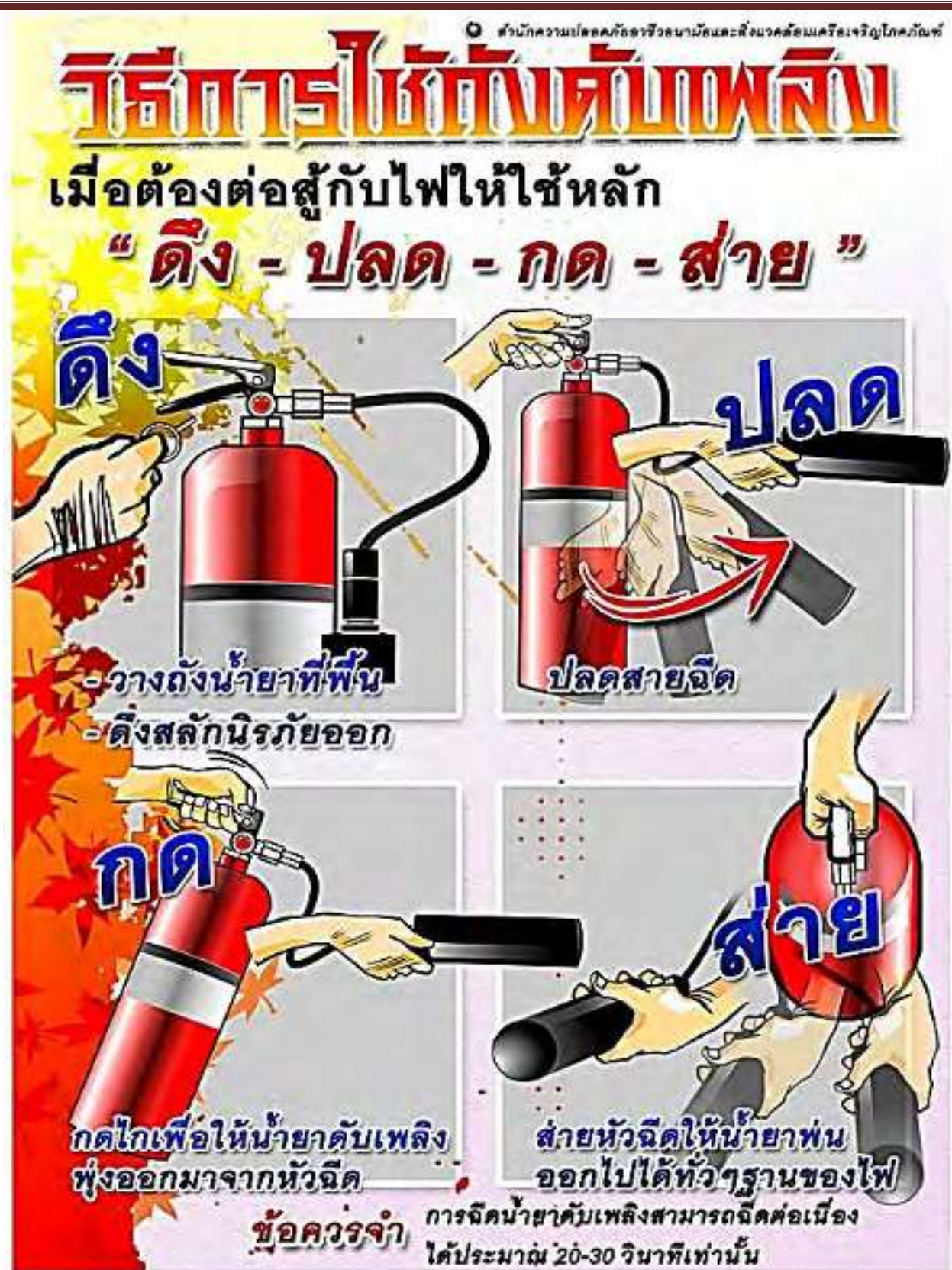
ภาพที่ 29 วิธีการใช้ถังดับเพลิง
