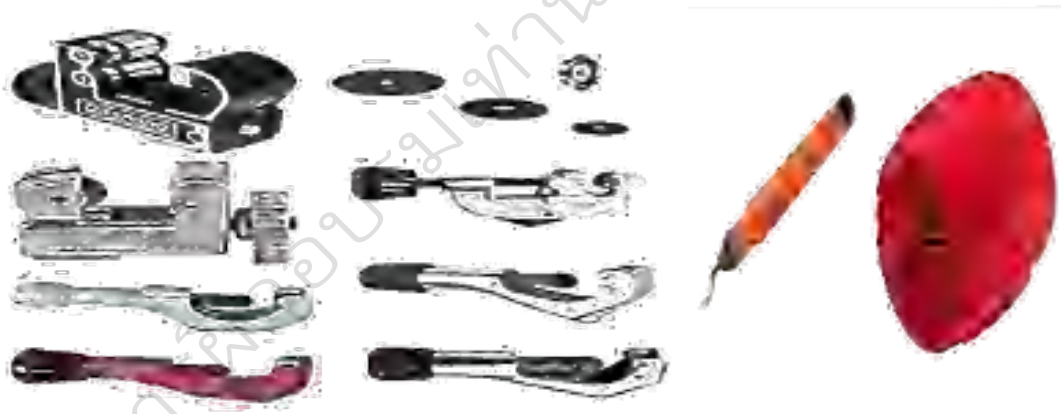
ภาพที่ 312 ตัวอย่างคัตเตอร์ตัดท่อทองแดง และรีมเมอร์ลบคมท่อ
