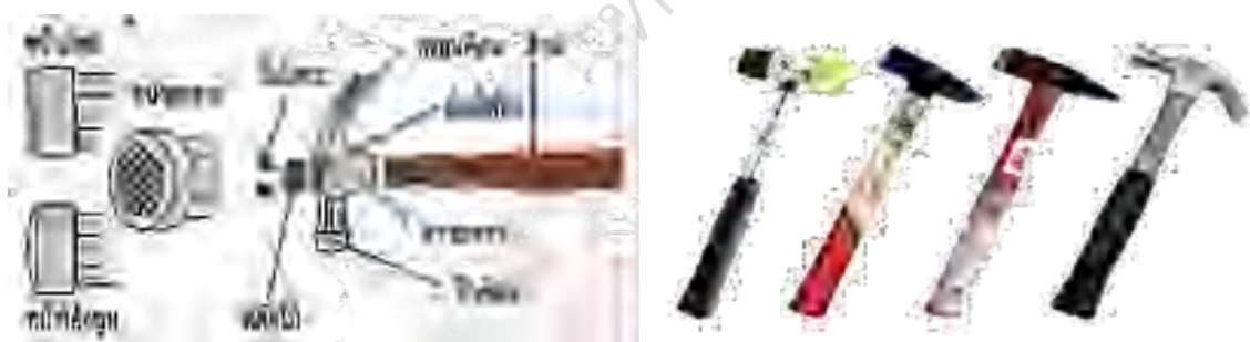
ภาพที่ 84 ตัวอย่างส่วนประกอบของค้อน
