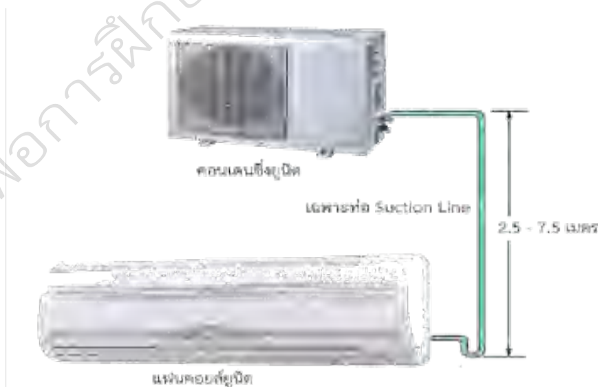
ภาพที่ 372 การติดตั้งท่อ PMtrap
