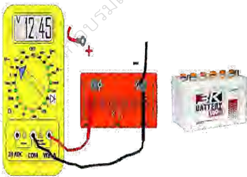
ภาพที่ 220 ตัวอย่างการวัดแบตเตอรี่ ด้วย มัลติมิเตอร์ดิจิทัล
