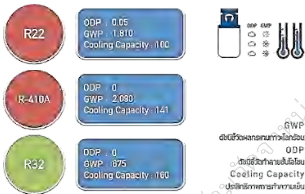
ภาพที่ 287 แสดงคุณสมบัติของ R22 , R410A และ R32
