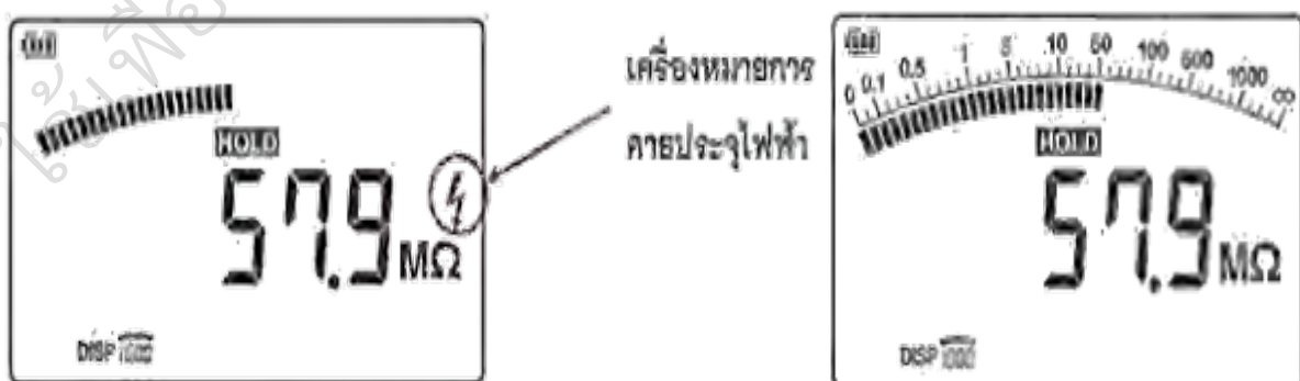
ภาพที่ 242 แสดงการคายประจุไฟฟ้า ของ Insulation tester รุ่น Ir 4057 ของ Hio Ki
