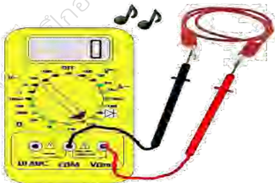
ภาพที่ 222 ตัวอย่างการวัดความต่อเนื่อง ด้วย มัลติมิเตอร์ดิจิทัล
