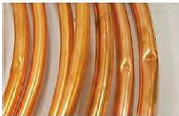
ภาพที่ 310 แสดงความเสียหายต่อท่อทองแดงเนื่องจากจัดเก็บไม่ถูกต้อง
