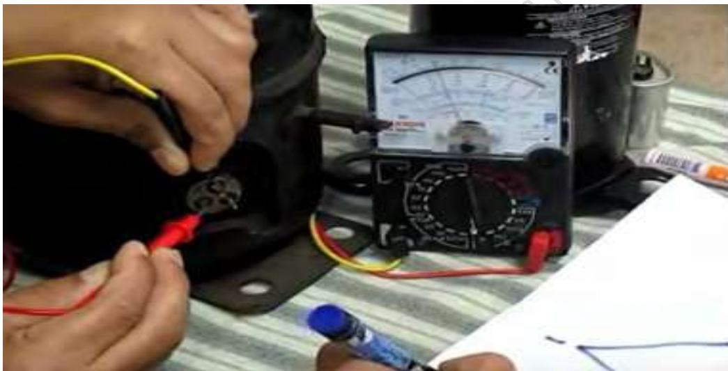
ภาพที่ 326 แสดงการวัดขั้วของมอเตอร์คอมเพรสเซอร์โดยใช้ มัลติมิเตอร์
