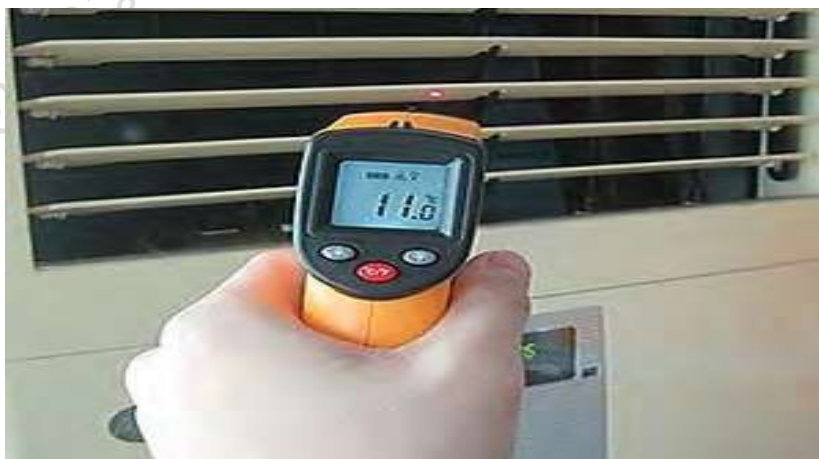
ภาพที่ 260 ตัวอย่างการใช้เทอร์โมมิเตอร์แบบอินฟราเรด ในงานเครื่องปรับอากาศ
