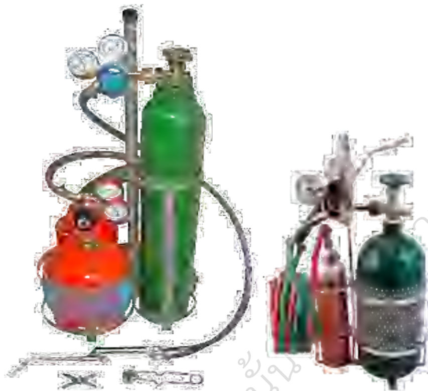
ภาพที่ 321 ตัวอย่างชุดเชื่อมต่อท่อทองแดงสำหรับงานเครื่องปรับอากาศ
