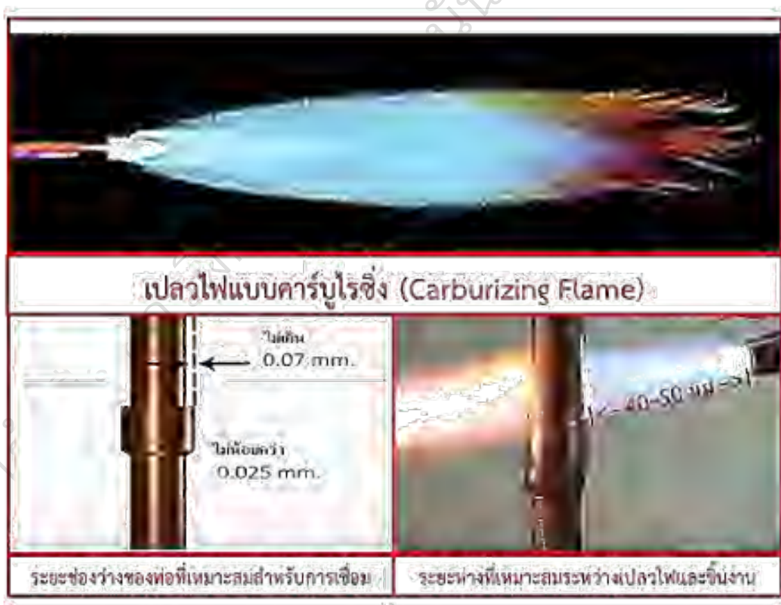
ภาพที่ 320 แสดงขั้นตอนการเชื่อมต่อท่อทองแดง
