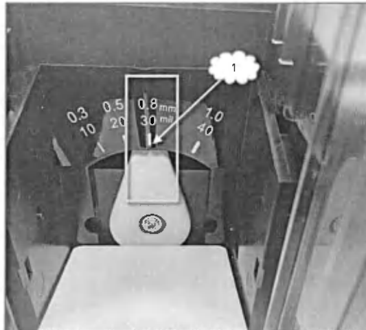
(1) ตรวจสอบการเลือกความหนาของบัตรพลาสติกที่ใช้งานว่าตั้งไว้ที่ 0.8 mm
