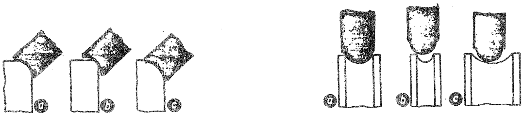
รูป ข วิธีสอบความโค้งกลมและร่อง ( a) ความโค้ง โค้นขนาดพอดี ( b) ความโค้งน้อยไป ( c) ความโค้งมากไป
