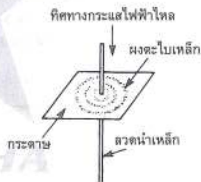
รูปที่ 26 ลักษณะของเส้นแรงแม่เหล็กที่เกิดขึ้น รอบๆ ลวดนำ
