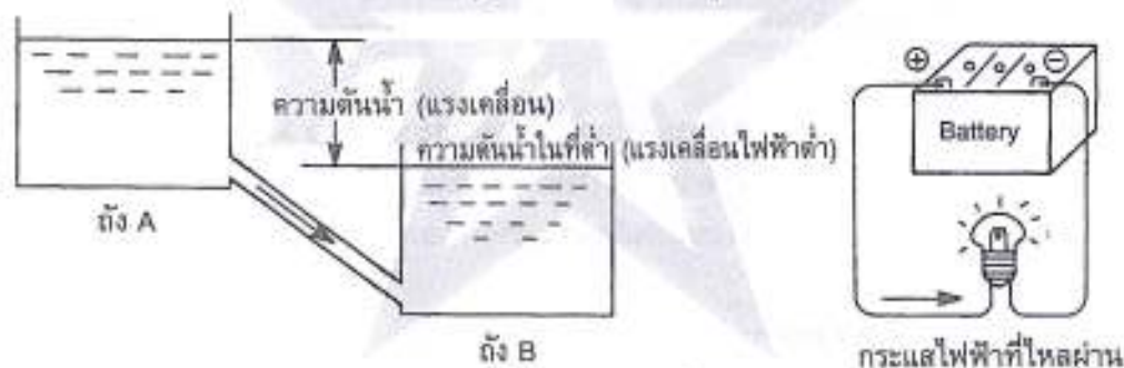
รูปที่ 30 เปรียบเทียบการไหลของน้ำและกระแสไฟฟ้า
