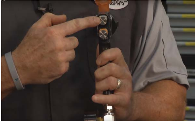
รูปที่ 7 วาล์วปรับแต่งปริมาณสีและแรงดันลม
