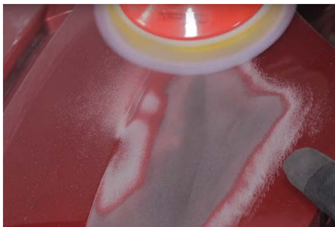
รูปที่ 4 การขัดพื้นผิวด้วยเครื่องขัดละเอียด
