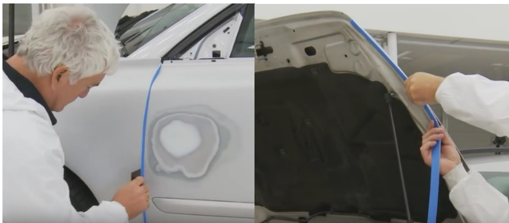
รูปที่ 11 การติดเทปโฟม
