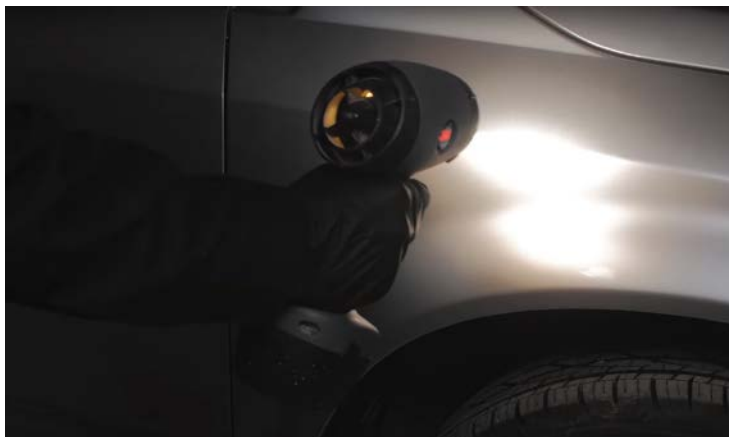
รูปที่ 1 การตรวจสอบด้วยไฟฉายแสงอาทิตย์
