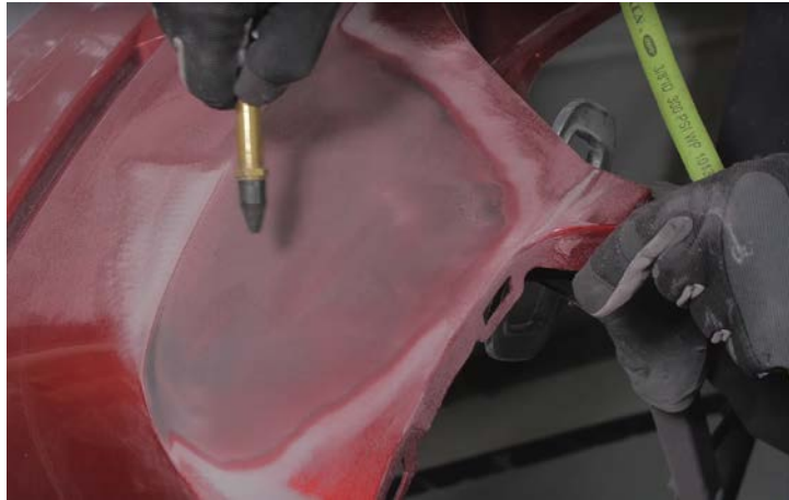
รูปที่ 5 การทำความสะอาดผิวงานด้วยลม
