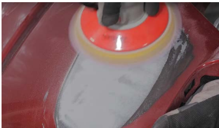
รูปที่ 8 การขัดซีลเลอร์ด้วยเครื่องขัด
