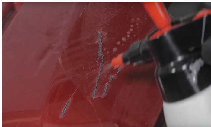
รูปที่ 1 การพ่นน้ำยากำจัดคราบไขมัน
