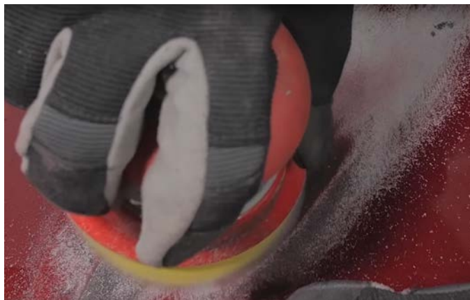
รูปที่ 3 การขัดพื้นผิวด้วยเครื่องขัดหยาบ
