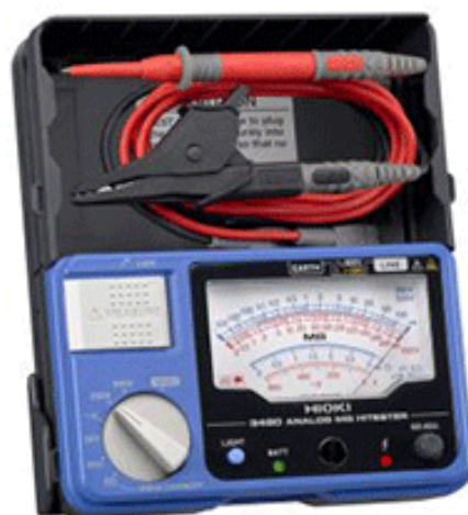
รูปที่ 9.12 เครื่องมือวัด Mega Ohm
