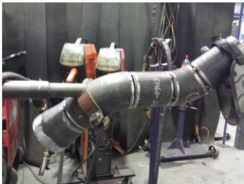
รูปที่ 5.1 การใช้อุปกรณ์จับยึดประกอบท่อให้ได้มุมที่ต้องการ
