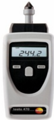
รูปที่ 7.1 เครื่องวัดความเร็วรอบ (Tachometer) แบบทางกล
