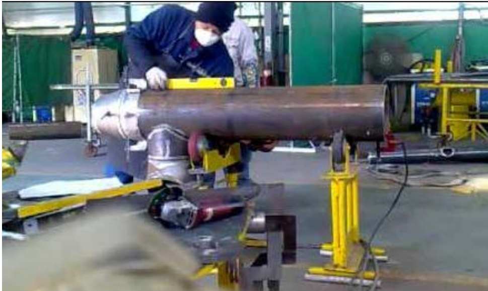
รูปที่ 5.2 การใช้อุปกรณ์จับยึดเพื่อช่วยงาน
