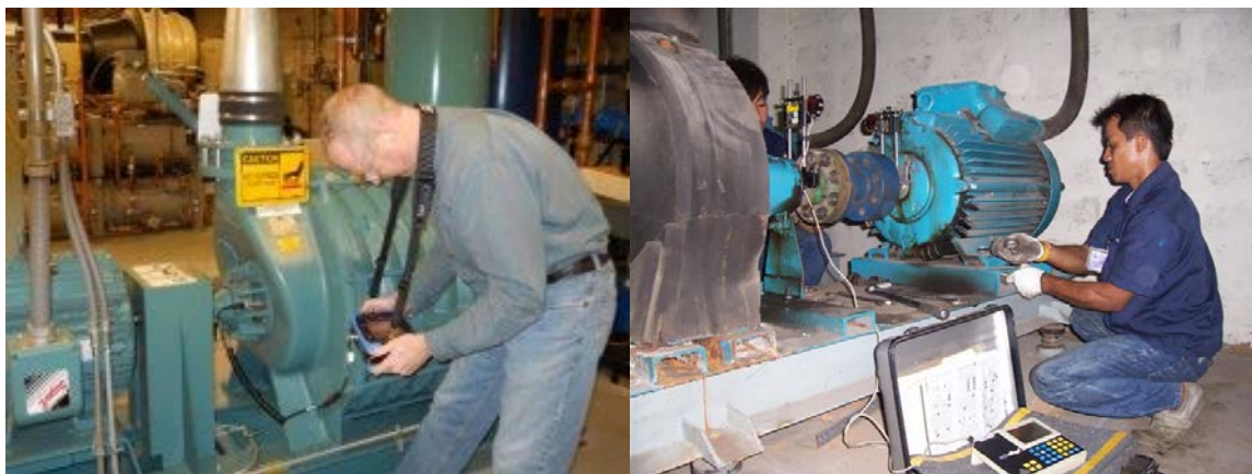
รูปที่ 14.2 ตัวอย่างการตรวจสอบการสั่นคลอนด้วยอุปกรณ์เครื่องวัดแรงสั่นสะเทือน
