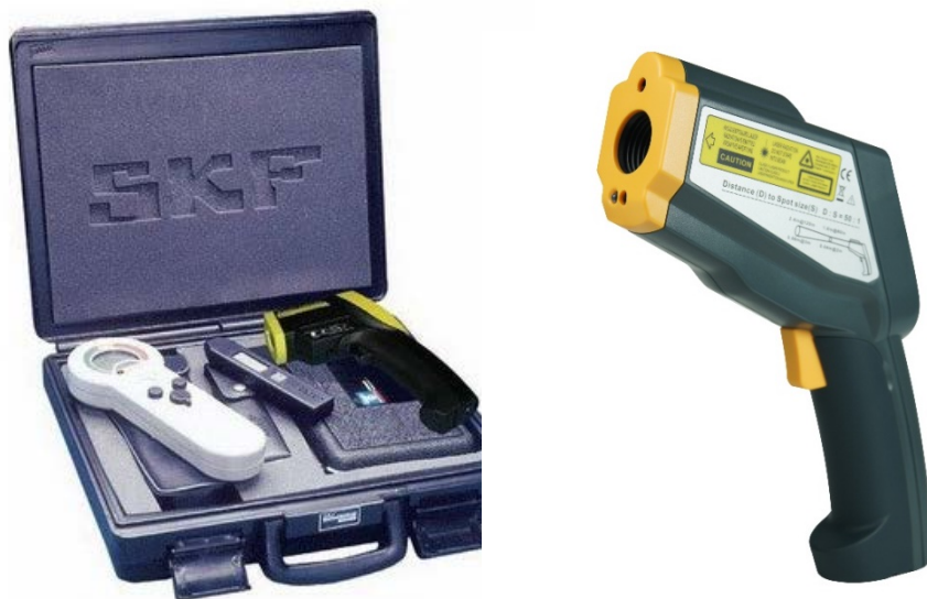
รูปที่ 10.4 เครื่องวัดอุณหภูมิ (Infrared Thermometer)
