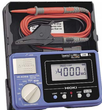
รูปที่ 10.5 เครื่องมือ Mega Ohm meter สำหรับตรวจสอบค่าความเป็นฉนวนของขดลวด
