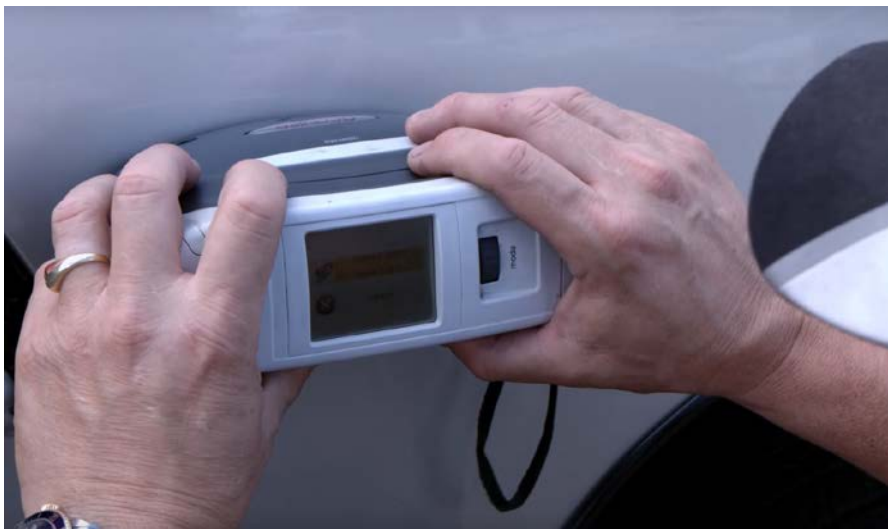
รูปที่ 10 ตรวจสอบความหนาสีและตัวถังด้วยเครื่องวัดความหนา
