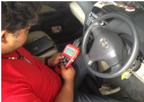
รูปที่ 2 การตรวจสอบระบบควบคุมการทำงานของน้ำมัน
