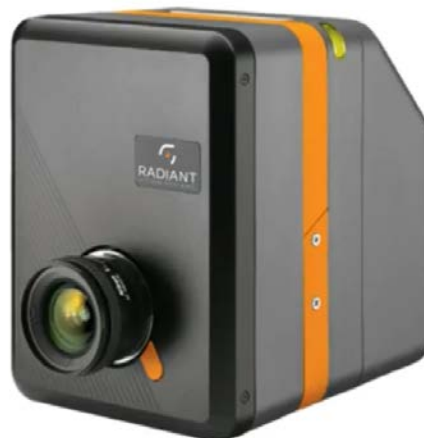
รูปที่ 6 กล้องเซ็นเซอร์ตรวจจับภาพเพื่อตรวจสอบระดับสูงต่ำรถยนต์
