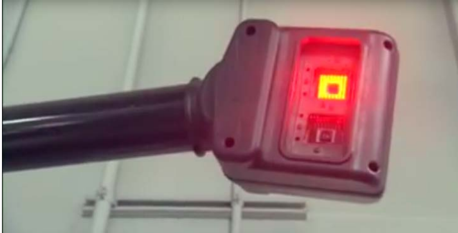
รูปที่ 7 กล้องเซ็นเซอร์ตรวจสอบองศาของศษูนย์ล้อ
