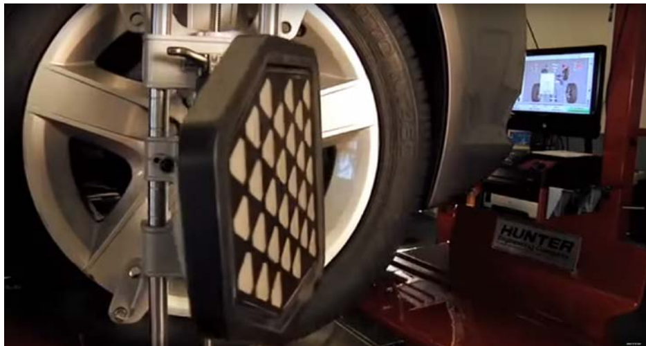
รูปที่ 3 เปิดเครื่องตรวจสอบศูนย์ล้อให้กล้องและเซ็นเซอร์ทำงานเพื่อวัดองศา
