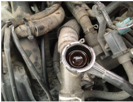
รูปที่ 12 น้ำหล่อเย็นและสภาพฝาหม้อน้ำ
