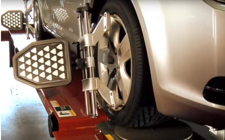
รูปที่ 2 ติดเซ็นเซอร์เข้ากับอุปกรณ์ยึดกับล้อ
