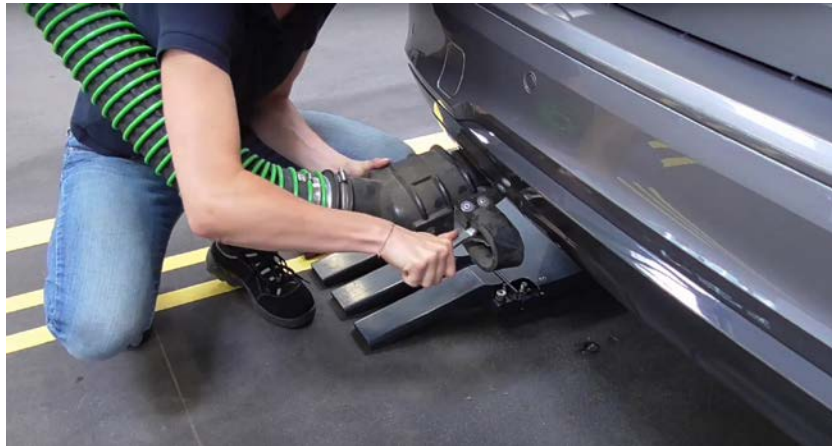
รูปที่ 6 ต่อสายไอเสียกรณีติดตั้งเครื่องยนต์ช่วงทดสอบ
