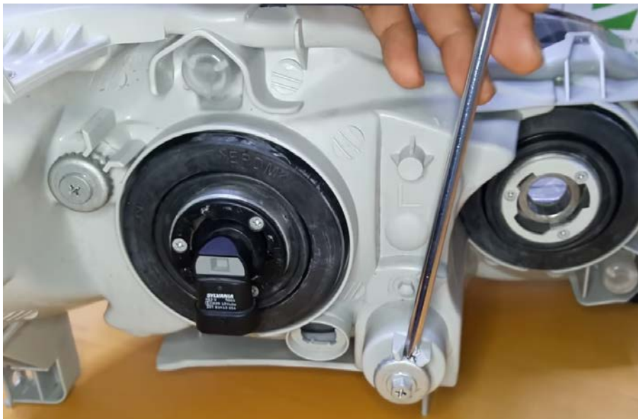
รูปที่ 11 ตำแหน่งสกรูชั้นปรับระดับมุมสูง-ต่ำ WL(Z) (รูปล่าง) และมุมกว้าง BL(Z) (รูปบน)
