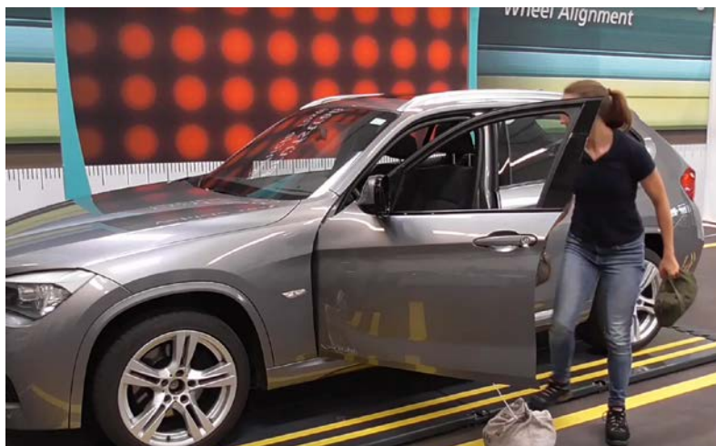
รูปที่ 7 ถ่วงน้ำหนักรถที่ประมาณ 75 กิโลกรัมแทนการนำหนักผู้โดยสาร
