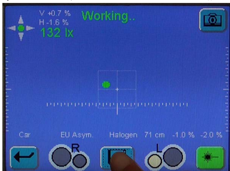
รูปที่ 11 ลำแสงไฟพุ่งสูงจากเครื่องก่อนการปรับตั้งค่าแสดงว่าอยู่รับได้จะปรากฏสีเขียว
