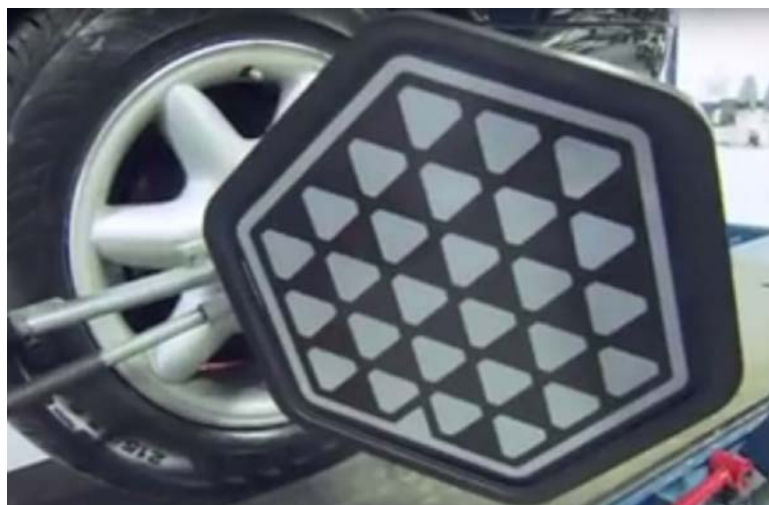
รูปที่ 6 เซ็นเซอร์จับองศาศูนย์ล้อ
