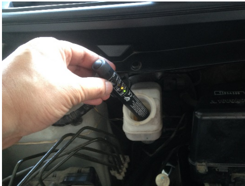
รูปที่ 16 การทดสอบความชื้นในน้ำมันเบรก
