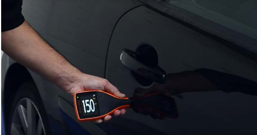
รูปที่ 9 ตรวจสอบคุณภาพสีด้วยเครื่องวัดสี
