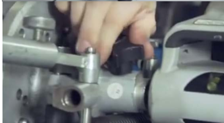
รูปที่ 2 ตรวจสอบการสภาพของอุปกรณ์เซ็นเซอร์จับยึดล้อ
