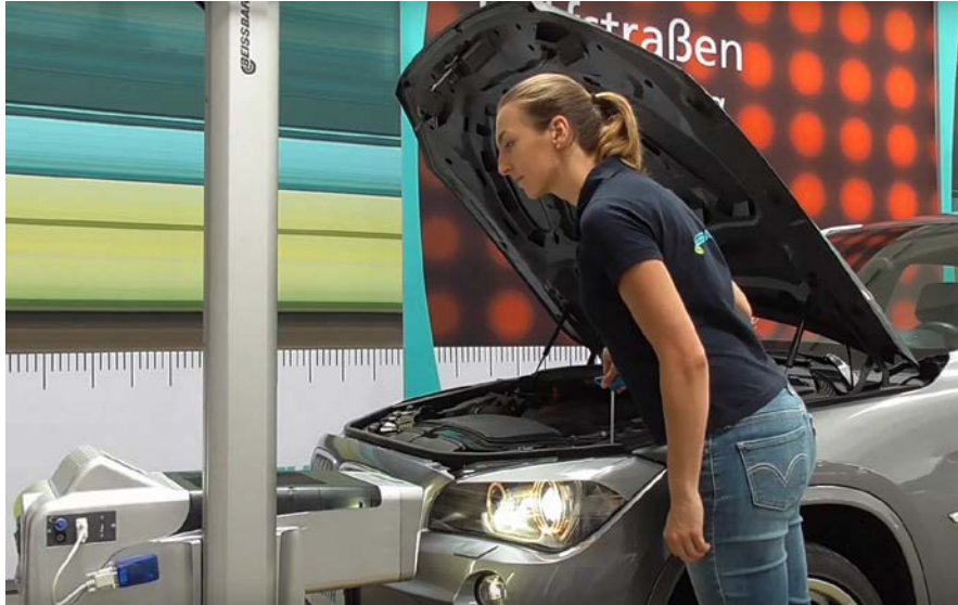
รูปที่ 9 การขันสกรูปรับตั้งความสูงต่ำให้ได้ตามมาตรฐาน
