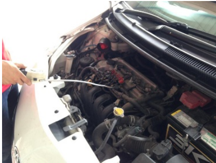
รูปที่ 7 เช็คราว์ซึมของท่อแก๊สและท่อน้ำมัน ท่อต่างๆ
