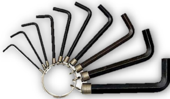
รูปที่ 4.6 แสดงลักษณะของประแจรูปตัวแอล (ที่มา : http://www.inventor.in.th/home/ประแจ-wrench/ )
