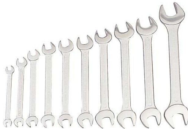
รูปที่ 4.4 แสดงประแจปากตายเบอร์ต่างๆ (ที่มา : http://toolmonger.com/2007/12/page/2/ )
