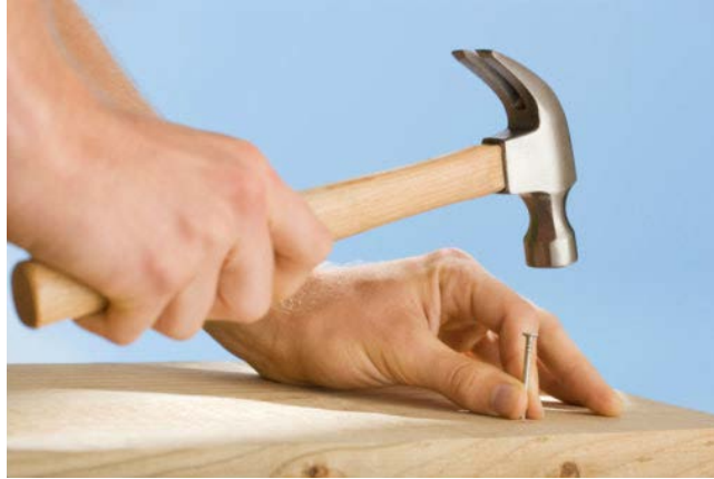
รูปที่ 6.10 แสดงการใช้งานค้อนหงอน (ที่มา : http://www.vcharkarn.com/blog/116163/94759 )
