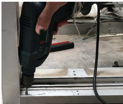
รูปที่ 4.12 แสดงการใช้งานสว่านไฟฟ้าชนิดธรรมดา (ที่มา : https://realmartonline.com/ )
