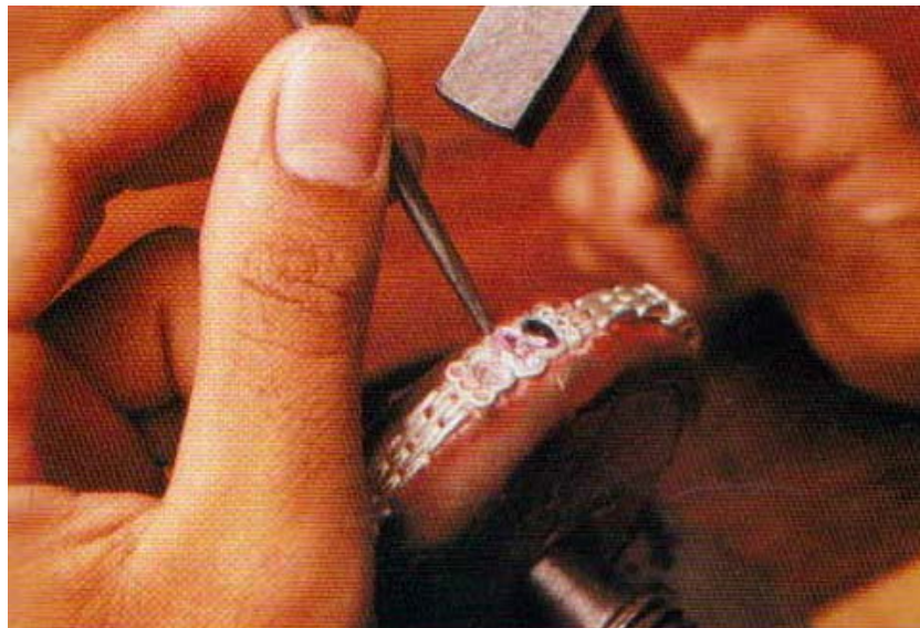
รูปที่ 1 การใช้เหล็กตอกไล่ขอบกระเปาะเพื่อยึดเกาะพลอย (ที่มา : สมาคมผู้ค้าอัญมณีไทยและเครื่องประดับ. 2541. การประดับอัญมณี)
