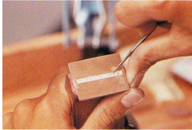
รูปที่ 9 เหล็กจิกไขปลา (ที่มา : สมาคมผู้ค้าอัญมณีไทยและเครื่องประดับ. 2541. การประดับอัญมณี)
