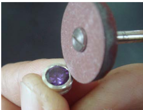
รูปที่ 13 การขัดชิ้นงานโดยใช้ลูกยาง
