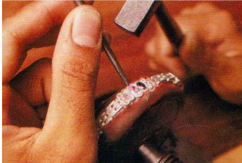
รูปที่ 7 การใช้เหล็กตอกไลขอบกระเปาะเพื่อยึดเกาะพลอย (ที่มา : สมาคมผู้ค้าอัญมณีไทยและเครื่องประดับ. 2541. การประดับอัญมณี)
