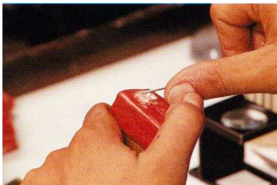
รูปที่ 7 การคว้านกระเปาะด้วยเหล็กชุด (ซ้าย) และดอกสว่านกรอกระเปาะ (ที่มา : สมาคมผู้ค้าอัญมณีไทยและเครื่องประดับ. 2541. การประดับอัญมณี)
