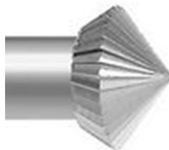
รูปที่ 7 การคว้านกระเปาะด้วยเหล็กชุด (ซ้าย) และดอกสว่านกรอกระเปาะ (ที่มา : สมาคมผู้ค้าอัญมณีไทยและเครื่องประดับ. 2541. การประดับอัญมณี)
