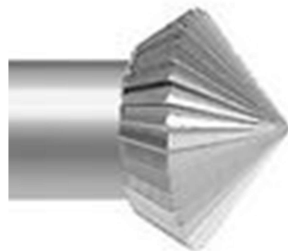
รูปที่ 7 การคว้านกระเปาะด้วยเหล็กชุด (ซ้าย) และดอกสว่านกรอกระเปาะ (ที่มา : สมาคมผู้ค้าอัญมณีไทยและเครื่องประดับ. 2541. การประดับอัญมณี)
