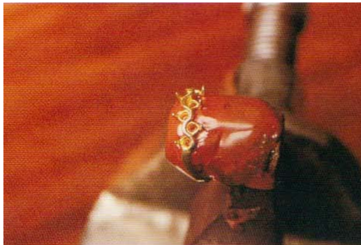
รูปที่ 2 แหวนที่ขึ้นครั่งเรียบร้อยแล้ว (ที่มา : สมาคมผู้ค้าอัญมณีไทยและเครื่องประดับ. 2541. การประดับอัญมณี)
