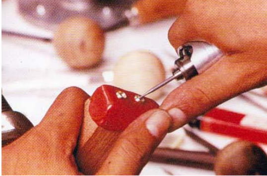
รูปที่ 9 การใช้เหล็กครอบตอกหุ้มกระเปาะพลอย (ที่มา : สมาคมผู้ค้าอัญมณีไทยและเครื่องประดับ. 2541. การประดับอัญมณี)
