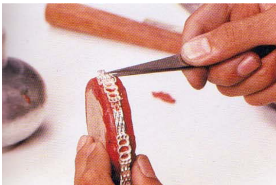
รูปที่ 3 การฝังพลอยแบบหุ้ม
