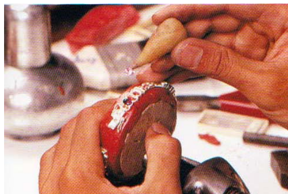
รูปที่ 3 การฝังพลอยแบบหุ้ม
