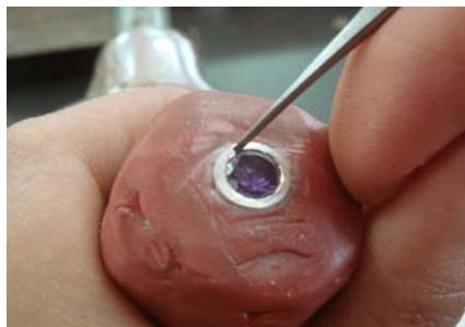
รูปที่ 7 การใช้อุปกรณ์เหล็กตัดในงานฝังแบบฝังหุ้ม
