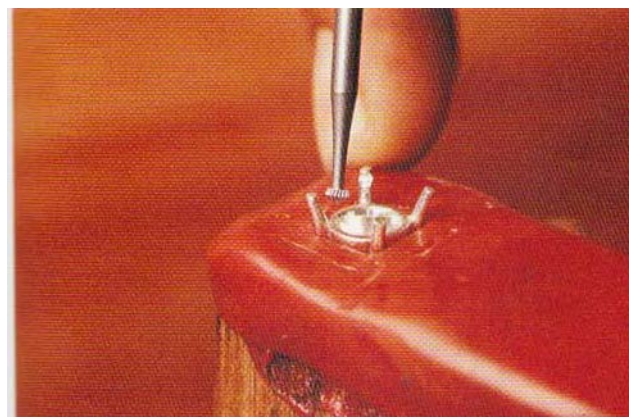
รูปที่ 4 การกรอหนามเตย (ที่มา : สมาคมผู้ค้าอัญมณีไทยและเครื่องประดับ. 2541. การประดับอัญมณี)
