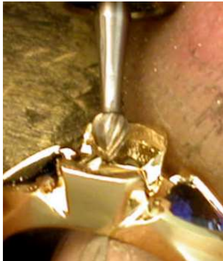
รูปที่ 3 ดอกสว่านแบบกลม (Bud Bur) (ที่มา : https://www.ganoksin.com )
