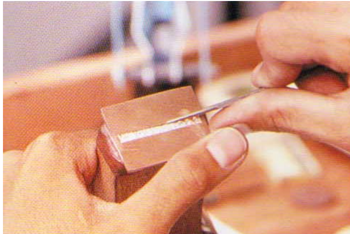
รูปที่ 5 ตัดขอบให้เรียบร้อม
