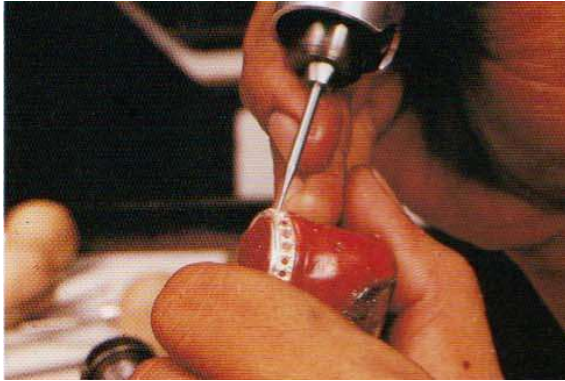
รูปที่ 6 การใช้เหล็กปั่นไขปลาทดแทนเตย (ที่มา : สมาคมผู้ค้าอัญมณีไทยและเครื่องประดับ. 2541. การประดับอัญมณี)
