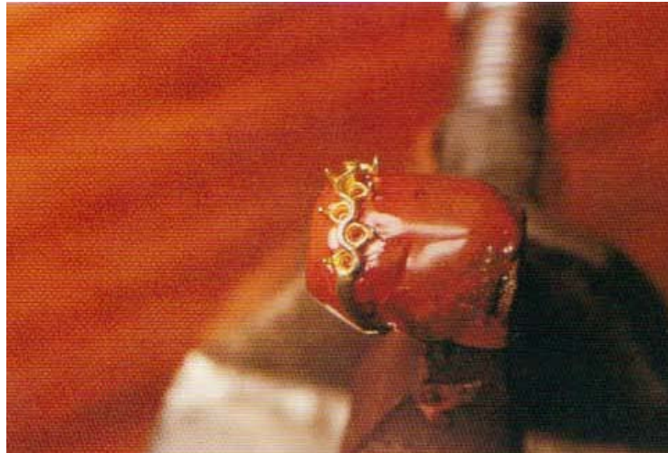
รูปที่ 5 แหวนที่ขึ้นครั่งเรียบร้อยแล้ว (ที่มา : สมาคมผู้ค้าอัญมณีไทยและเครื่องประดับ. 2541. การประดับอัญมณี)
