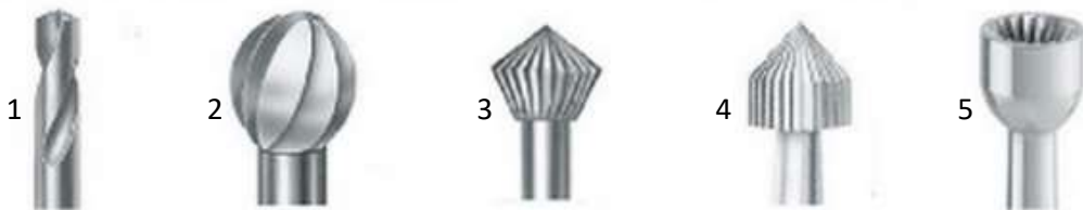
รูปที่ 4 ดอกสว่านแบบต่าง ๆ จากซ้ายไปขวา 1) หัวสว่าน 2) เม็ดมะยมหรือหัวสว่านกลม 3) ดอกสว่านถ้วย หรือดอกสว่านจานบิน 4) ดอกสว่านกรอนั่งพลอย 5) เหล็กครอบ
