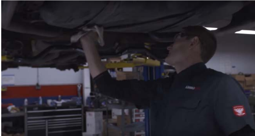
รูปที่ 6 การทำความสะอาดพื้นผิวก่อนพ่นแอนเดอร์โค้ดด้วยผ้าแท็กแกล็ค
