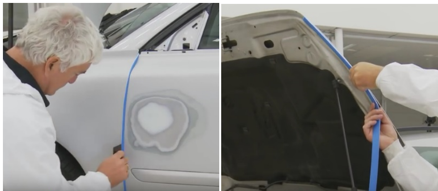
รูปที่ 4 การติดเทปโฟม
