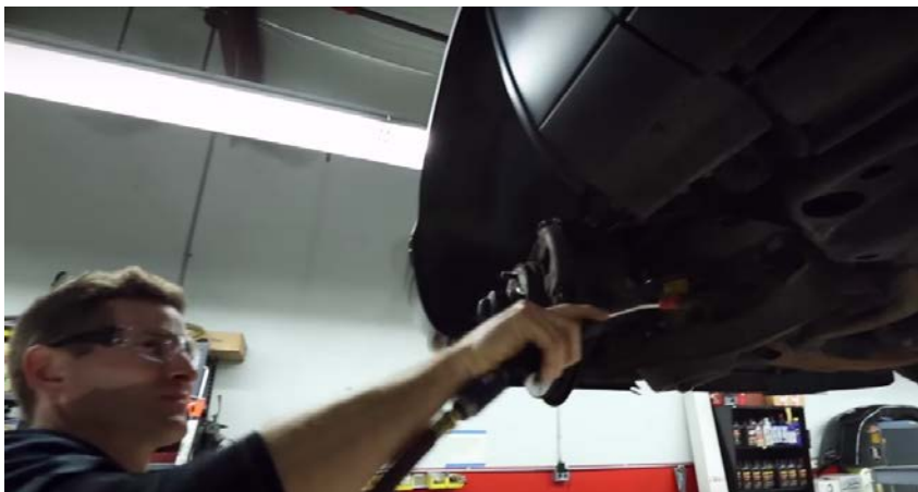
รูปที่ 7 เป่าฝุ่นผงด้วยลม
