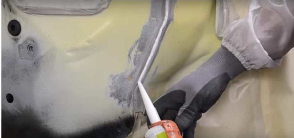
รูปที่ 3 การขัดแต่งพื้นผิวก่อนการซีลเลอร์
