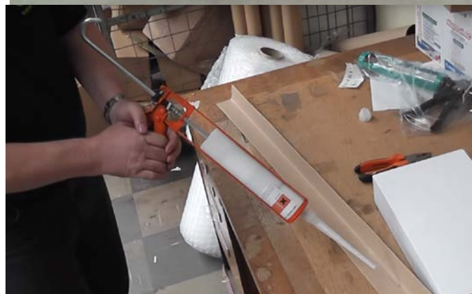
รูปที่ 5 การทดสอบแรงดันปืนซีลเลอร์
