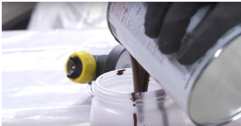
รูปที่ 8 ผสมแอนเดอร์เทโค้ดลงในกาพ่น
