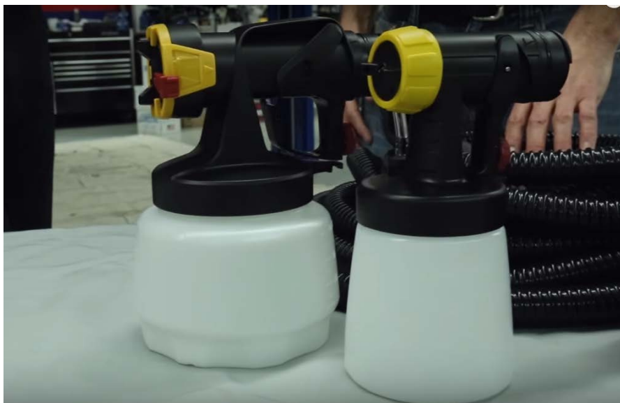
รูปที่ 13 ปืนหัวใหญ่จะใช้กับแอนเดอร์โค้ดชั้น ปืนหัวเล็กใช้กับแอนเดอร์โค้ดใส
