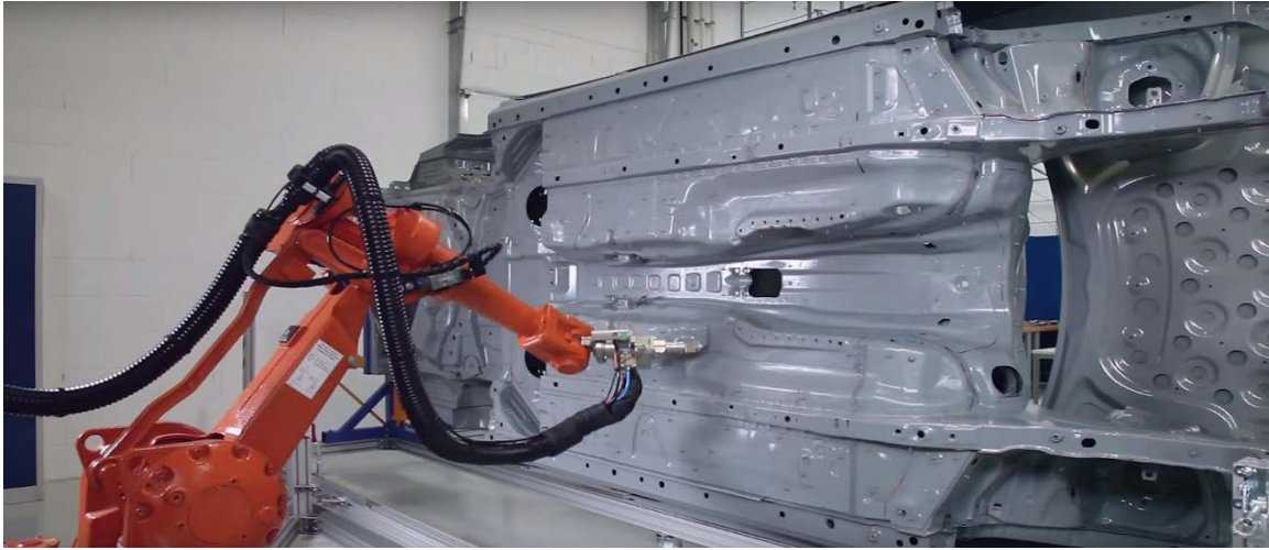
รูปที่ 2 การซีลเลอร์ตัวถังด้วยเครื่องจักร แขนกล
