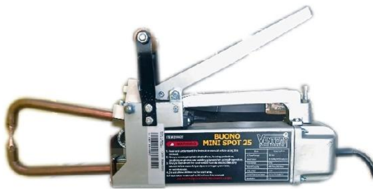
รูปที่ 4 ปืนสปอตเชื่อมชิ้นงาน
