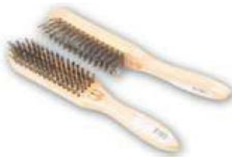
รูปที่ 5.9 แสดงลักษณะแปรงลวด
