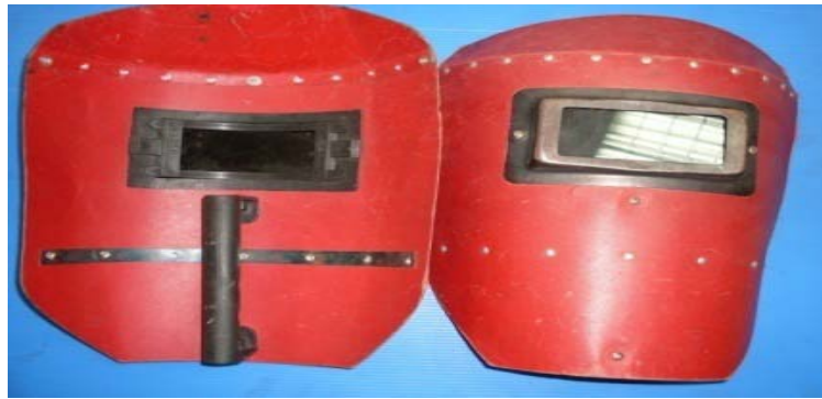
รูปที่ 8.5 ลักษณะหน้ากากเชื่อมชนิดมือถือ
