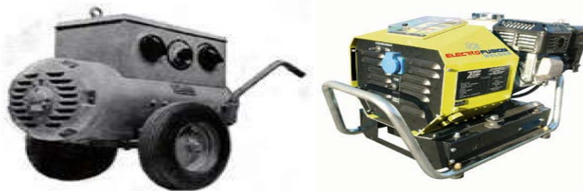
รูปที่ 2.6 ลักษณะเครื่องเชื่อมเจนเนอเรเตอร์โดยใช้มอเตอร์ไฟฟ้าและเครื่องยนต์
