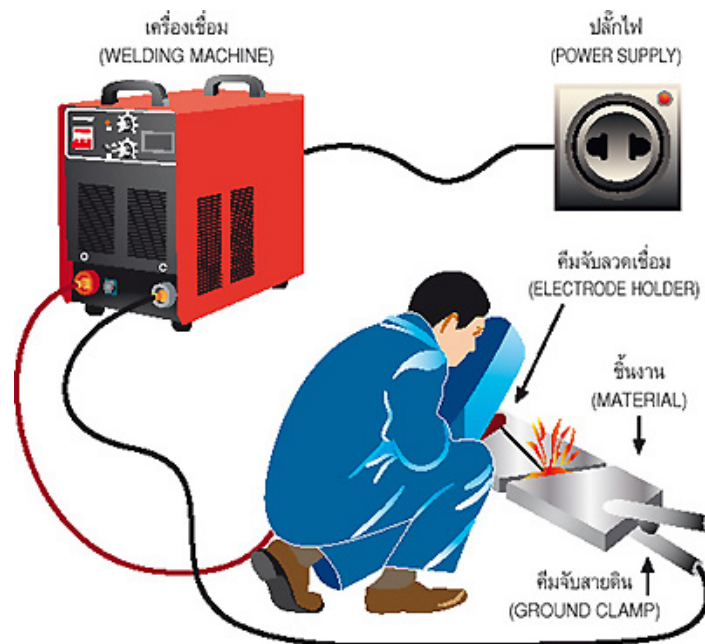
รูปที่ 2.17 การเชื่อมสายต่อสายกราวด์
