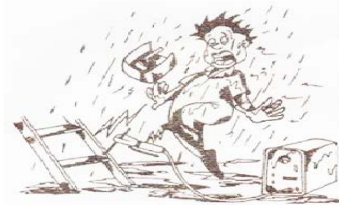
รูปที่ 15.7 อันตรายจากการเชื่อมกลางสายฝนหรือพื้นเปียกน้ำ
