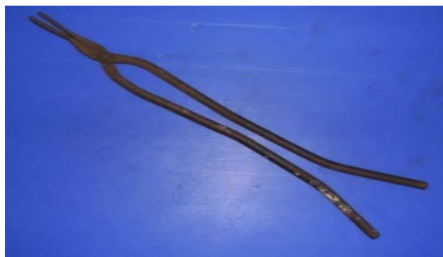
รูปที่ 5.10 แสดงลักษณะคีมจับชิ้นงานร้อน
