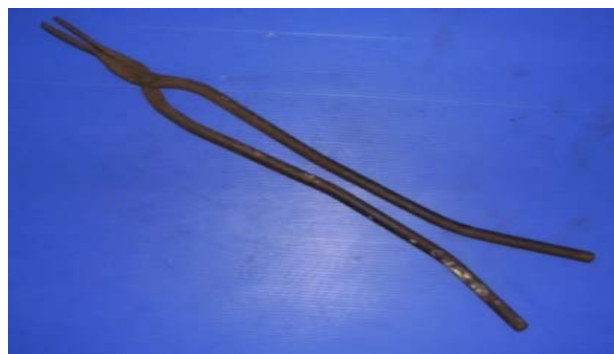
รูปที่ 11.10 แสดงลักษณะคีมจับชิ้นงานร้อน
