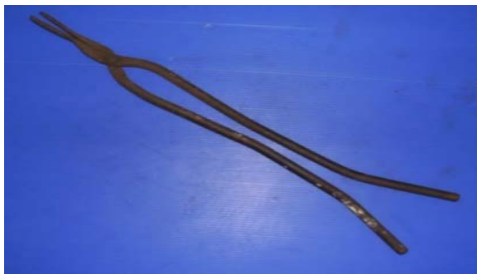
รูปที่ 8.10 แสดงลักษณะคีมจับชิ้นงานร้อน
