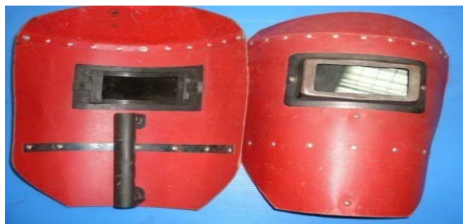
รูปที่ 11.5 ลักษณะหน้ากากเชื่อมชนิดมือถือ
