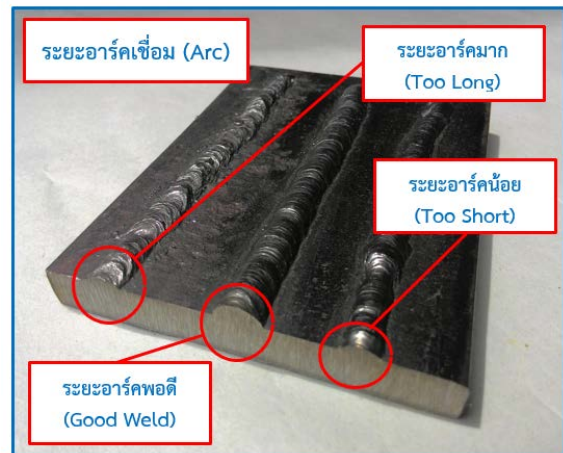
รูปที่ 9.20 การตรวจสอบแนวเชื่อม
