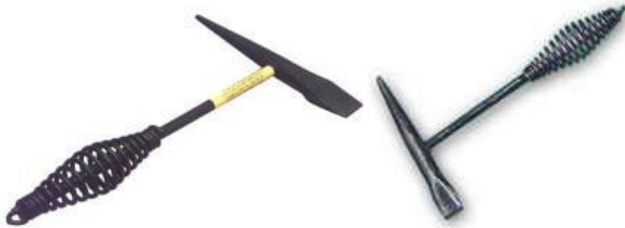
รูปที่ 11.8 แสดงลักษณะค้อนเคาะสแลก
