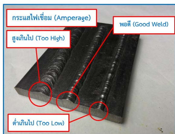
รูปที่ 6.4 เปรียบเทียบผลลัพธ์การปรับกระแสไฟในการเชื่อม
