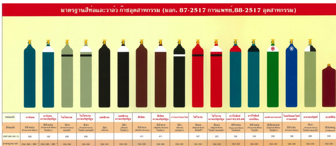
รูปที่ 2.18 สีของภาชนะบรรจุก๊าซในโรงงานอุตสาหกรรมตาม มอก.88-2517
