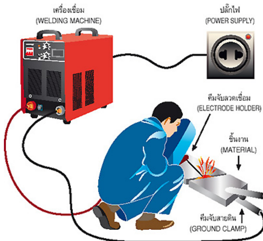
รูปที่ 4.1 การทำงานของเครื่องเชื่อมและจุดตรวจเช็ค
