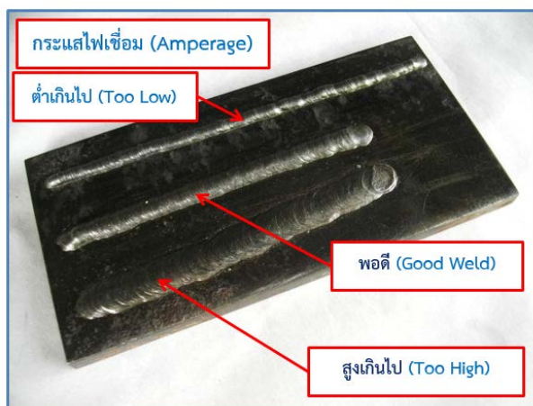
รูปที่ 9.4 เปรียบเทียบผลลัพธ์การปรับกระแสไฟในการเชื่อม
