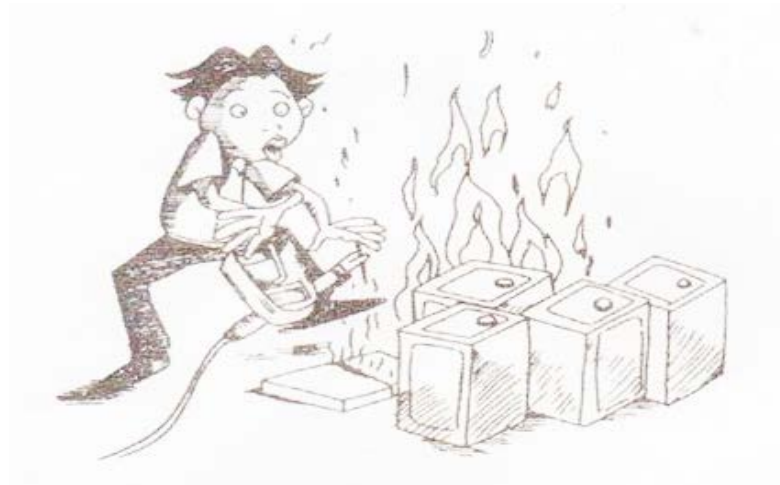
รูปที่ 15.8 อย่าเชื่อมใกล้ถังน้ำมันเชื้อเพลิง
