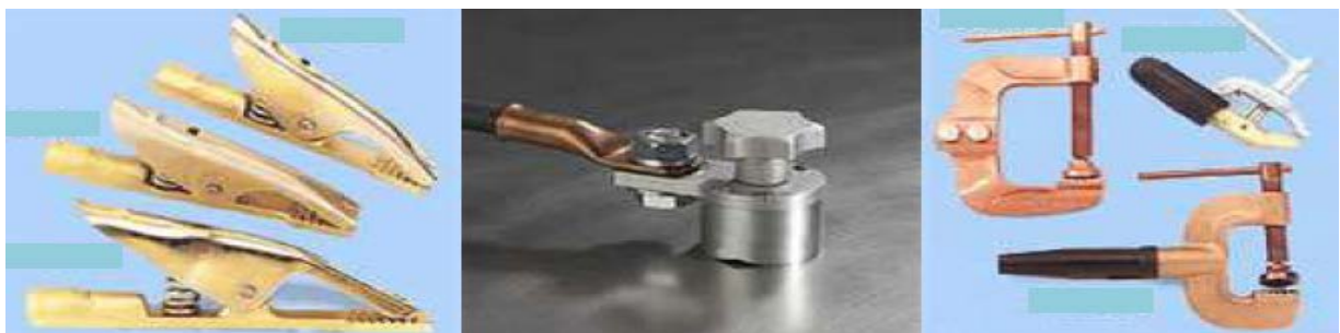
รูปที่ 11.4 ลักษณะอุปกรณ์จับยึดชิ้นงาน
