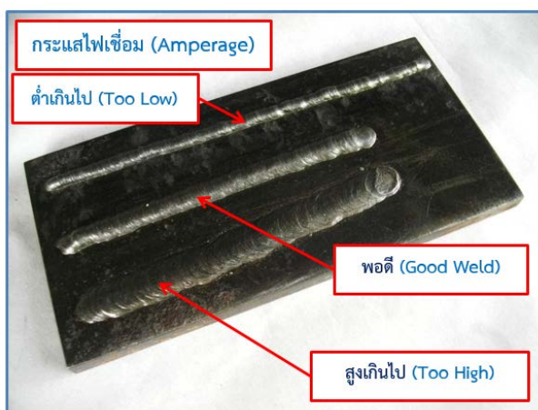
รูปที่ 6.4 เปรียบเทียบผลลัพธ์การปรับกระแสไฟในการเชื่อม
