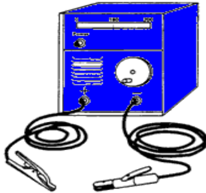
รูปที่ 2.10 ลักษณะเครื่องเชื่อมและการต่อขั้วสายเชื่อมแบบ DCEN
