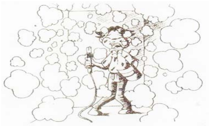
รูปที่ 15.9 การเชื่อมในห้องทึบ จะทำให้เกิดควันเป็นอันตรายต่อผู้เชื่อม
