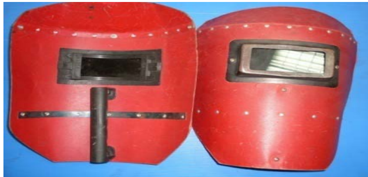
รูปที่ 5.5 ลักษณะหน้ากากเชื่อมชนิดมือถือ
