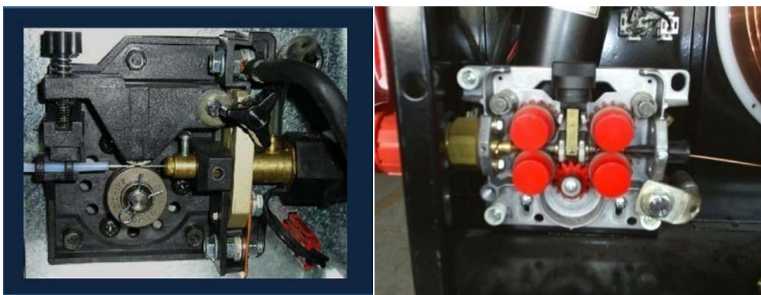
รูปที่ 2.13 ชุดป้อนลวดแบบล้อขับเดี่ยว (ซ้าย) และล้อขับคู่ (ขวา)
