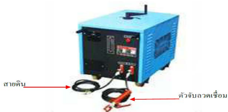
รูปที่ 11.2 ลักษณะการต่อสายเชื่อม
