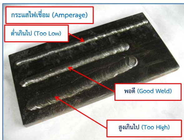
รูปที่ 12.4 เปรียบเทียบผลลัพธ์การปรับกระแสไฟในการเชื่อม
