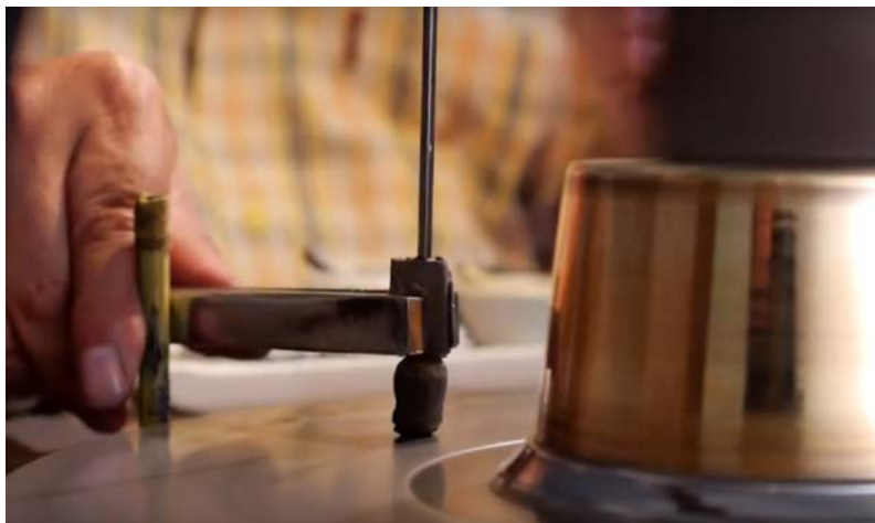
รูปที่ 4 การเจียรไนขัดเงาน้ำราบ (ที่มา : https://www.youtube.com/watch?v=E7pcSTgG9pc )
