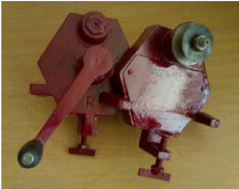
รูปที่ 8 หินแต่ง (ซ้าย) และเครื่องแต่งล้อหินตั้งโต๊ะ (ขวา) (ที่มา : http://www.anothaikarnchang.com )
