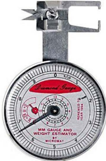
รูปที่ 3 มิลวัดพลอย เลเวอร์ริจ์ เกจ แบบเข็ม
