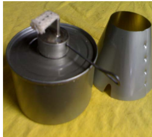
รูปที่ 5 ชะแล็กแผ่นสำหรับปั่นทวน (ซ้าย) และตะเกียงแอลกอฮอล์สำหรับติดพลอย (ขวา) (ที่มา : http://www.anothaikarnchang.com )
