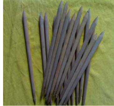
รูปที่ 9 ทวนเหล็ก (ซ้าย) ทวนไม้ (ขวา) (ที่มา : http://www.anothaikarnchang.com )
