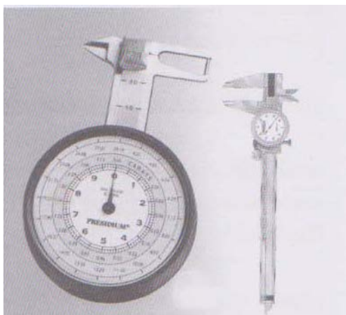
รูปที่ 8 จากซ้ายไปขวา : เครื่องมือวัดพลอย / ตาชั่งพลอย (ที่มา : สมาคมผู้ค้าอัญมณีไทยและเครื่องประดับ. 2541. การเจียรไนพลอย)
