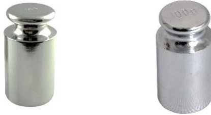
รูปที่ 4 ตุ้มสอบเทียบน้ำหนักขนาด 100 กรัม (ที่มา : https://www.เครื่องชั่งไทย.com )
