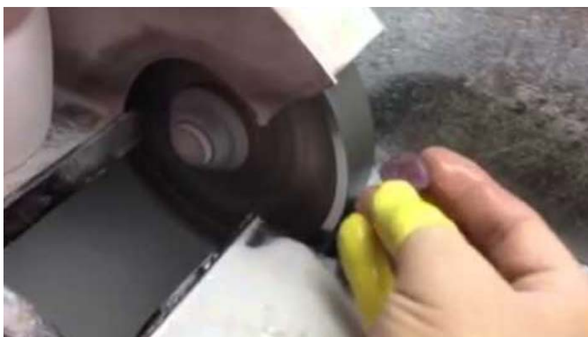
รูปที่ 14.5 ขัดผิวก่อนพลอยด้วยเครื่องเจียรไนแบบล้อหินตั้งโต๊ะ
