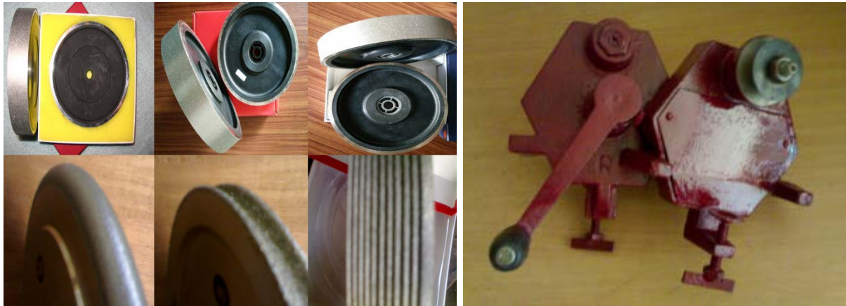
รูปที่ 6 หินแต่ง (ซ้าย) และเครื่องแต่งแบบหมุนมือ (ขวา)
