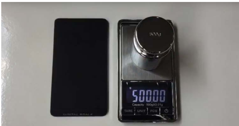
รูปที่ 5 การใช้งานตุ้มสอบเทียบน้ำหนัก (ที่มา : https://www.เครื่องชั่งไทย.com )
