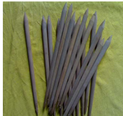
รูปที่ 7 ทวนเหล็ก (ซ้าย) ทวนไม้ (ขวา) (ที่มา : http://www.anothaikarnchang.com )
