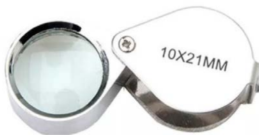
รูปที่ 1 กล้องดูพลอยขนาดกำลังขยายของเลนส์ 10 เท่า
