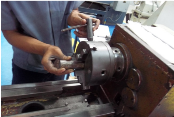
รูปที่ 5.1 แสดงการจับยึดชิ้นงานบนเครื่องกลึง
