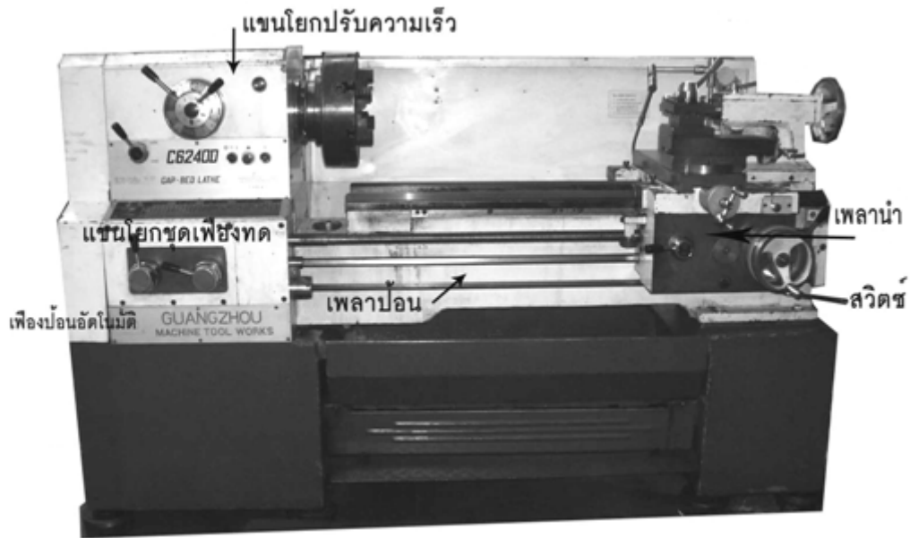
รูปที่ 4.6 ส่วนประกอบของชุดระบบป้อน
