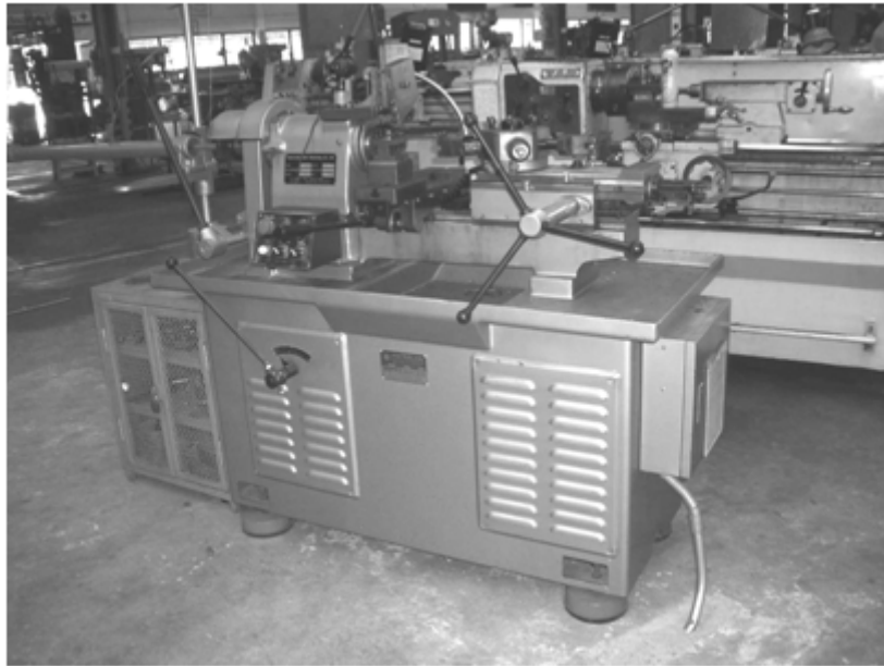
รูปที่ 4.20 เครื่องกลึงเทอเรตแนวนอน (Horizontal Turret Lathe)
