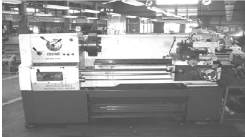
รูปที่ 4.22 เครื่องกลึงยืนศูนย์ (Center Lathe)
