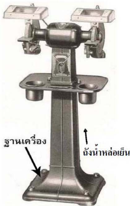
รูปที่ 3.10 ฐานเครื่อง ถังน้ำ หล่อเย็น
