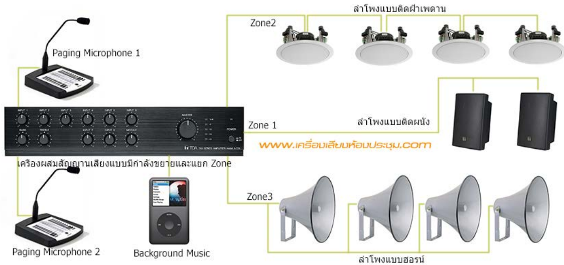
รูปที่ 9.3 ระบบเสียงประกาศ (Public Address System)
