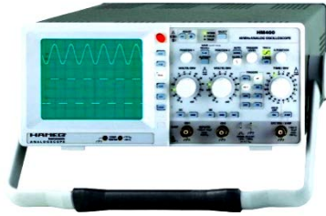
ภาพที่ 10.4 แสดงรูปออสซิลโลสโคปแบบแอนะล็อก (Analog) และแบบดิจิทัล (Digital)
