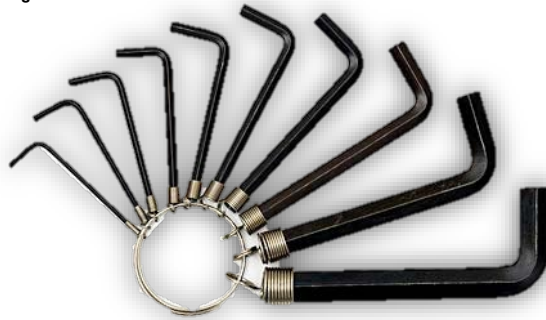
รูปที่ 7.3 แสดงลักษณะของประแจรูปตัวแอล (ที่มา : http://www.inventor.in.th/home/ประแจ-wrench/ )
