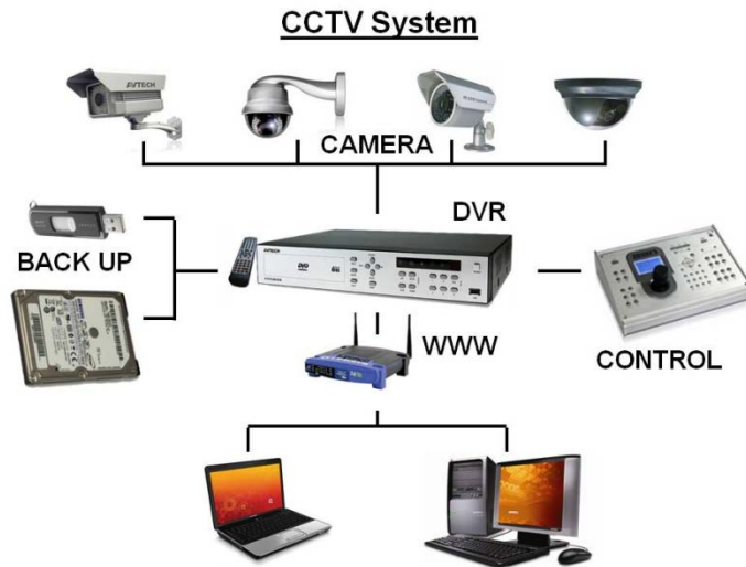
รูปที่ 9.1 การทำงานของกล้องวงจรปิด CCTV (Closed Circuit Television System)
