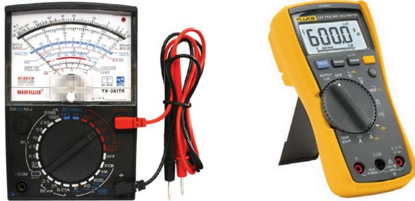
ภาพที่ 10.1 แสดงมัลติมิเตอร์แบบเข็มชี้และแบบตัวเลข
