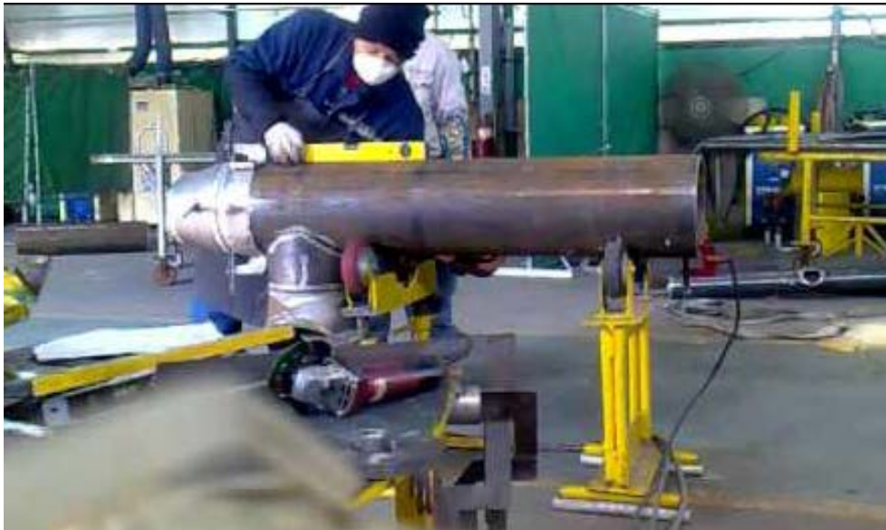
รูปที่ 2 แสดงการใช้อุปกรณ์จับยึดเพื่อช่วยงาน
