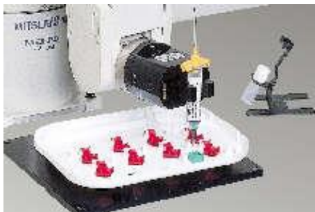
รูปที่ 4.0.1c: งานประกอบชิ้นส่วนทั่วไปโดยหุ่นยนต์ทำหน้าที่หยอดกาว
