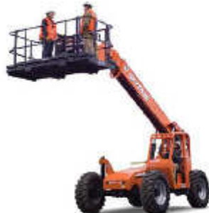
ย้ายคน elevated work platform
