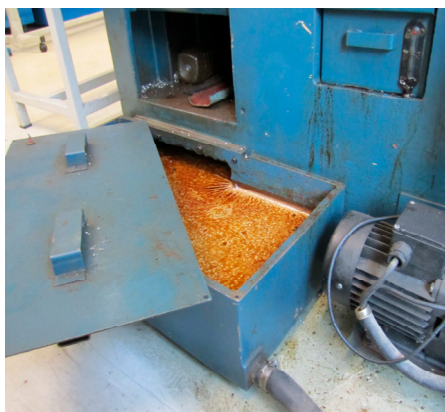
ภาพแสดงถังบรรจุสารหล่อเย็นที่ส่วนฐานเครื่อง
