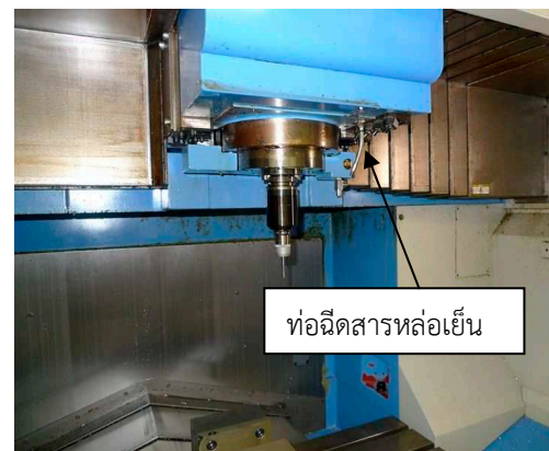
ภาพแสดงการติดตั้งท่อฉีดสารหล่อเย็นที่ชุดเพลากัด
