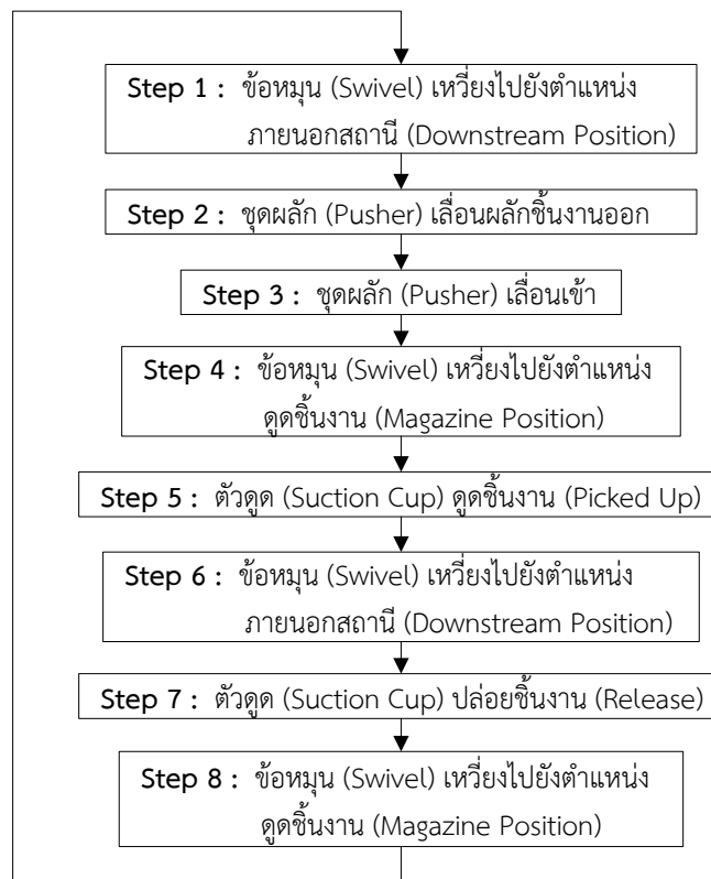
รูปที่ 7 แสดงโฟลว์ชาร์ตลำดับการทำงานของ Distributing Station
