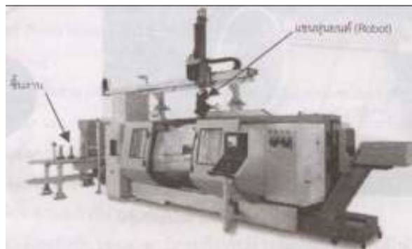
รูปที่ 17 แสดงชุดแขนหุ่นยนต์จับชิ้นงานออกจากเครื่องกลึง
