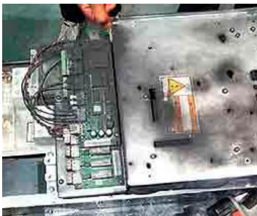
รูป 1 แสดงผงฝุ่นที่ถูกพัดลมเป่าเข้าไปในอินเวอร์เตอร์
