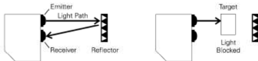
รูปที่ 2.7 การติดตั้ง Photoelectric Sensor แบบ Reflective Scan
