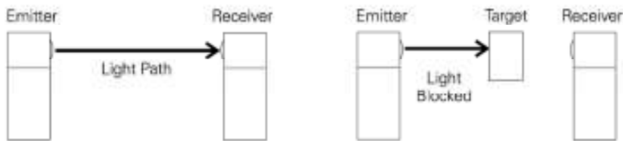
รูปที่ 2.6 การติดตั้ง Photoelectric Sensor แบบ Thru-Beam
