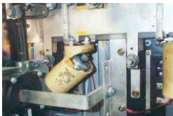
รูป 4 แสดงความเสียหายของตัวเก็บประจุของอินเวอร์เตอร์ ที่ทนแรงดันเกินพิกัด
