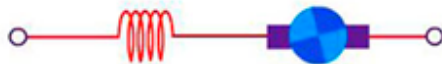
รูปที่ 28 วงจรการทำงานของยูนิเวอร์แซลมอเตอร์
