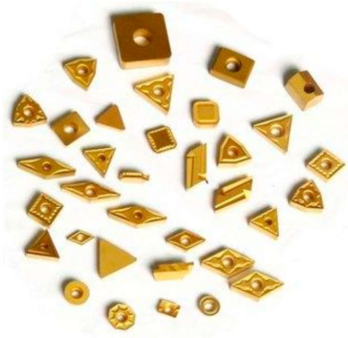
รูปที่ 2.3 รูปร่างของเม็ดอินเสิร์ท (Insert) แบบต่าง ๆ
