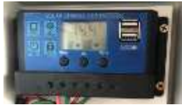
control Charge ขนาด ๕๐ A แรงดัน ๑๒ V
