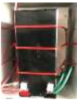
แบตเตอรี่ ขนาด ๗ W แรงดัน ๑๒ V
