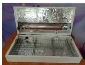
ภาพชุดอุปกรณ์ฆ่าเชื้อไวรัส COVID-19 ด้วยแสงอัลตราไวโอเลตซี (UVC) ควบคุมด้วยระบบอัตโนมัติ
