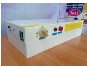
ภาพชุดอุปกรณ์ฆ่าเชื้อไวรัส COVID-19 ด้วยแสงอัลตราไวโอเลตซี (UVC) ควบคุมด้วยระบบอัตโนมัติ
