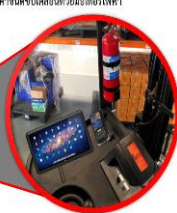
ภาพงานติดตั้งคอมพิวเตอร์ให้ผู้ใช้ระบบรถยกสินค้าขับเคลื่อนด้วยมอเตอร์ไฟฟ้า
