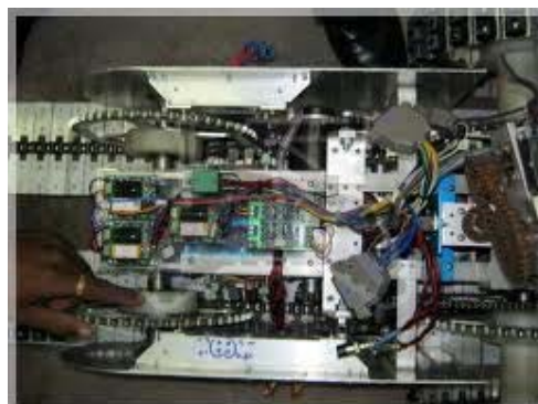
ภาพแสดงที่ 41 ชุดขับมอเตอร์ (Motor Driver)
