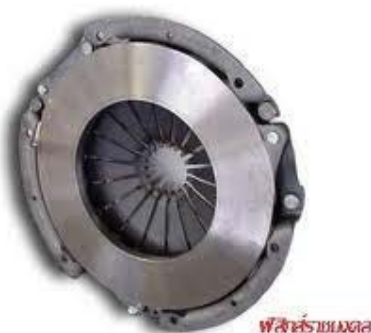
ภาพแสดงที่ 29 คลัตช์ (Clutch) คลัตช์เป็นอุปกรณ์ที่ทำหน้าที่ส่งถ่ายแรงบิดระหว่างเพลาสองเพลา
