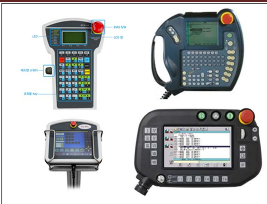
ภาพแสดงที่ 42 แสดงรูปแบบของ Programming Pendant แต่ละรูปแบบ
