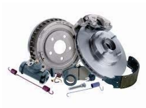
ภาพแสดงที่ 30 เบรก (Break) เบรกเป็นอุปกรณ์ควบคุมการเคลื่อนที่ของชิ้นส่วน
