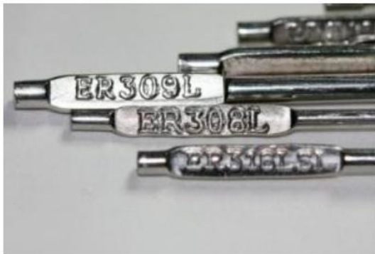
รูปที่ ๒๗ ลวดเติม ER ๓๐๘
