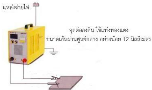
รูปที่ ๒๐ การต่อสายดิน
