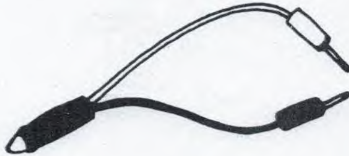
ลักษณะการต่อโดยใช้หลอดไฟสัญญาณ
