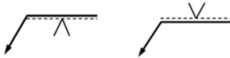
รูปที่ ๓๘ สัญลักษณ์การเชื่อมตรงข้ามหัวลูกศรชี้
