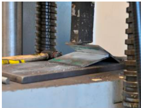
รูปที่ ๕๕ การทดสอบโดยการตีหัก
