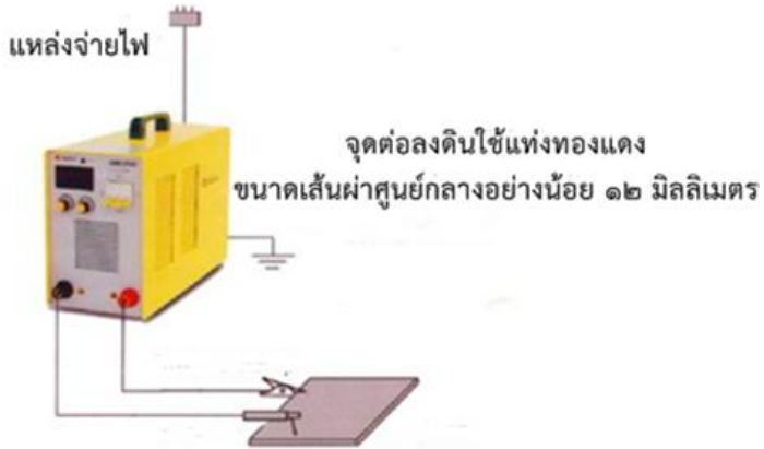
รูปที่ ๒๔ การต่อสายดินสายดิน
