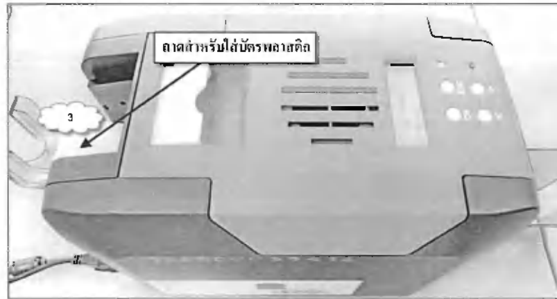
(3) นำบัตรพลาสติกใส่ในถาดใส่บัตรด้านหลังเครื่อง (ใส่ที่ละแผ่น)
