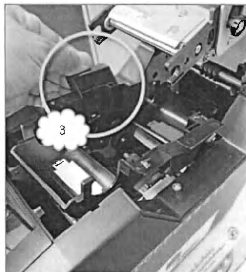
(3) นำแถบสี Ribbon ออกจากเครื่องพิมพ์บัตรโดยดึงแถบพลาสติกสีดำออกมาตามแนวยาวของตัวเครื่องพิมพ์บัตรพลาสติก
