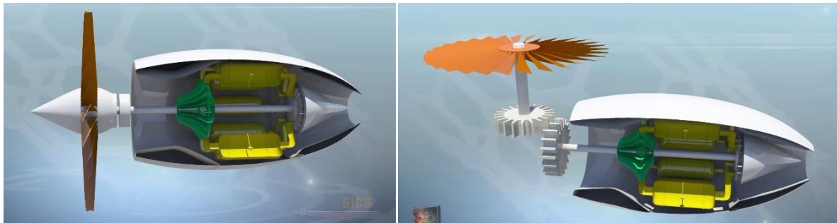
รูปที่ 49 ภาพจำลองแสดงการสร้างแรงขับเคลื่อนจากเครื่องยนต์กังหันแก๊สโดยใช้ใบพัดขนาดใหญ่ภายนอก
