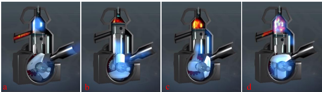
รูปที่ 34 แสดงการทำงานของเครื่องยนต์เบนซิน 2 จังหวะ ลูกสูบเคลื่อนขึ้นอัดไอดี (a) หัวเทียนสร้างประกายไฟจุดระเบิด (b) แก๊สขยายตัวดันลูกสูบเคลื่อนลง (c) และไอดีถูกอัดเข้ามาพร้อมกับดันไอเสียออกไป (d)
