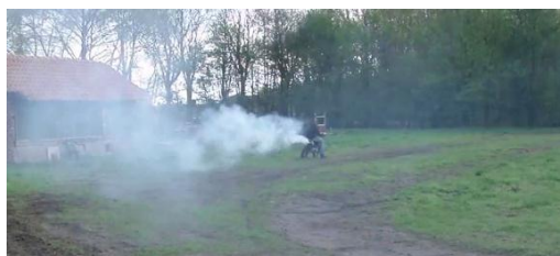
รูปที่ 35 ควันขาวซึ่งเกิดจากการเครื่องยนต์เบนซิน 2 จังหวะ
