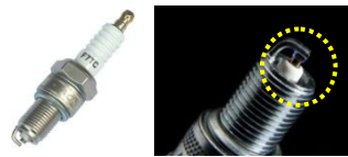
รูปที่ 19 หัวเทียน (ซ้าย) และประกายไฟจากหัวเทียน (ขวา) (ภาพจาก http://image.made-in-china.com/2f0j00CeHTIQRvBiD/Automobile-Spark-Plug-F77TC-.jpg และ http://static.zigwheels.com/media/content/2012/Nov/clean-spark-plug_560x420.jpg )
