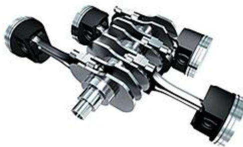
รูปที่ 16 การวางตัวของกระบอกสูบแบบบ็อกเซอร์ (ภาพจาก http://kevin-cohen.com/CARPICS/boxer_engine.jpg )
