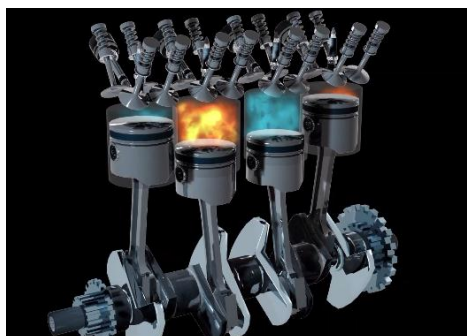
รูปที่ 14 ภาพจำลองแสดงภายในของเครื่องยนต์ 4 จังหวะ 4 กระบอกสูบเรียงแถว
