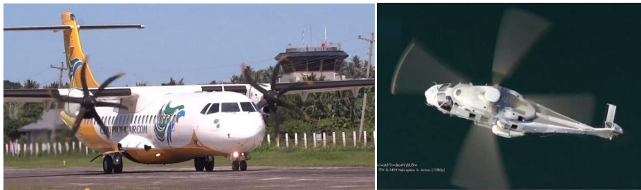
รูปที่ 50 ตัวอย่างอากาศยานที่ใช้การสร้างแรงขับเคลื่อนจากเครื่องยนต์กังหันแก๊สโดยใช้ใบพัดขนาดใหญ่ภายนอก
