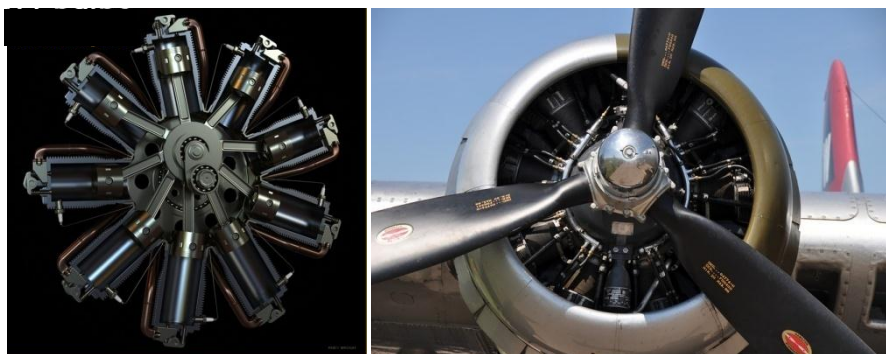
รูปที่ 22 ภาพจำลองแสดงลักษณะของเครื่องยนต์โรตารี (ซ้าย) และ เครื่องยนต์โรตารีถูกติดตั้งบริเวณปีกของเครื่องบิน(ขวา)
