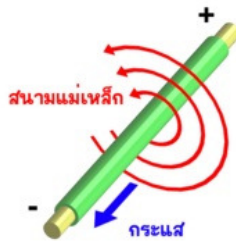
รูปที่ ๒.๑๗ เส้นแรงแม่เหล็กรอบตัวนำที่มีกระแสไฟฟ้าไหลผ่าน
